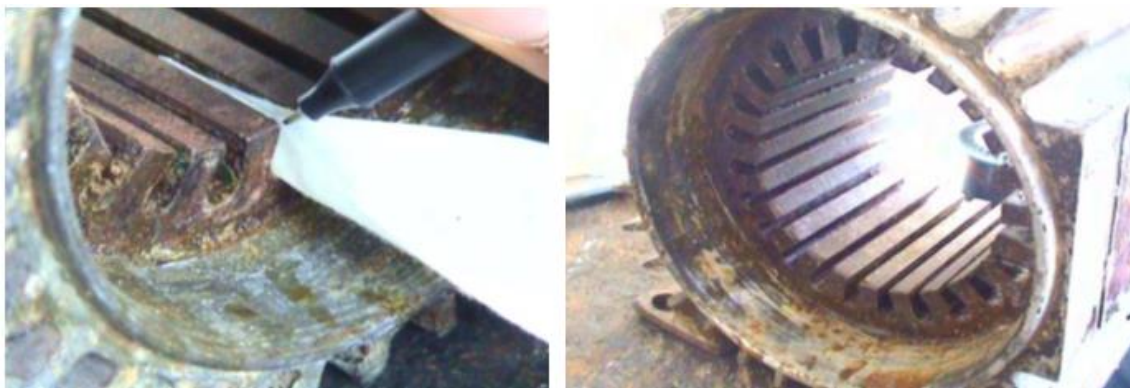
Ilustración 17. Medición de los cajetines y estar limpio preparado para recibir los cajetines de aislamiento. Fuente: [23].
