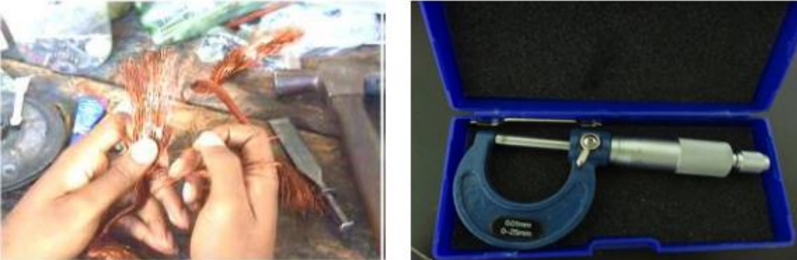
Ilustración 15. Contaje de espira de una bobina y un tornillo Micrométrico para medir diámetro de hilo esmaltado Fuente: Adaptada. Fuente: [23].
