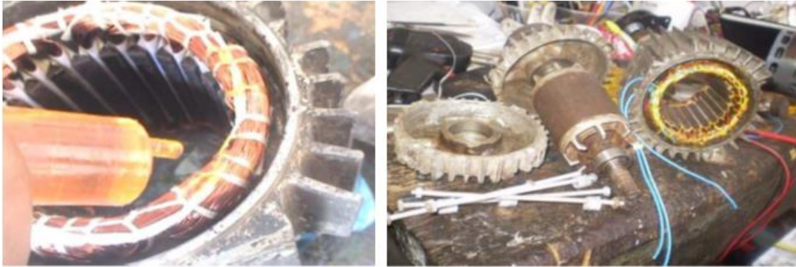
Ilustración 26. A la izda. El proceso de barnizado del estator y a la Dcha. Las piezas del motor preparadas. Fuente: [23].
