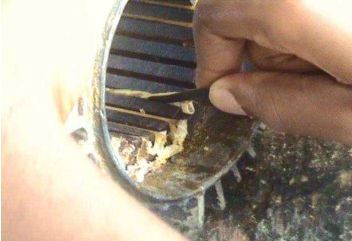
Ilustración 16. Limpieza de ranuras del estator. Fuente: [23].
