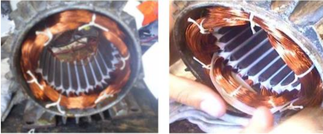
Ilustración 24. Aislado del lado de las cabezas sin conexiones. Fuente: [23].
