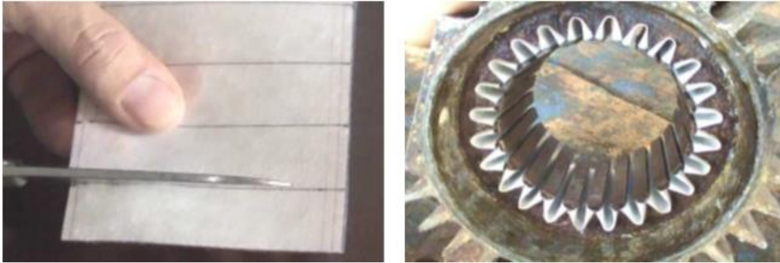
Ilustración 18. Confección de los cajetines para aislar las ranuras del estator. Fuente: [23].
