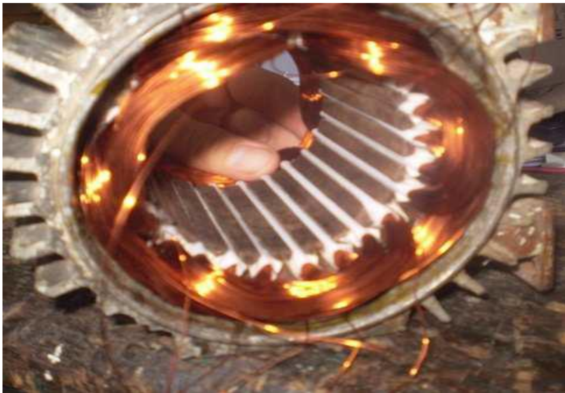
Ilustración 23. Estator completamente devanado. Fuente: [23].
