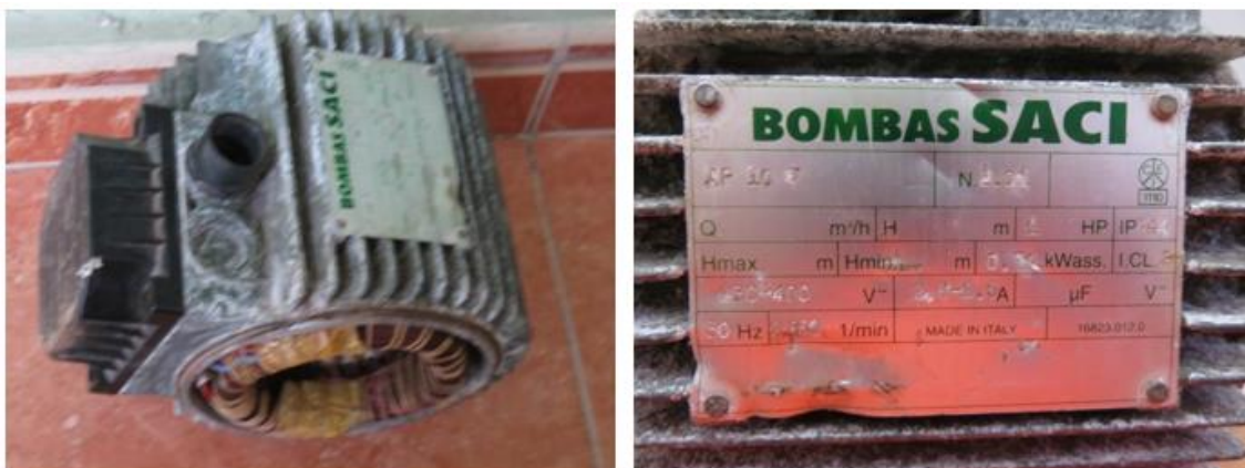
Ilustración 10. Estator del motor con su correspondiente placa de datos del motor a transformar. Fuente: Realización propia.
