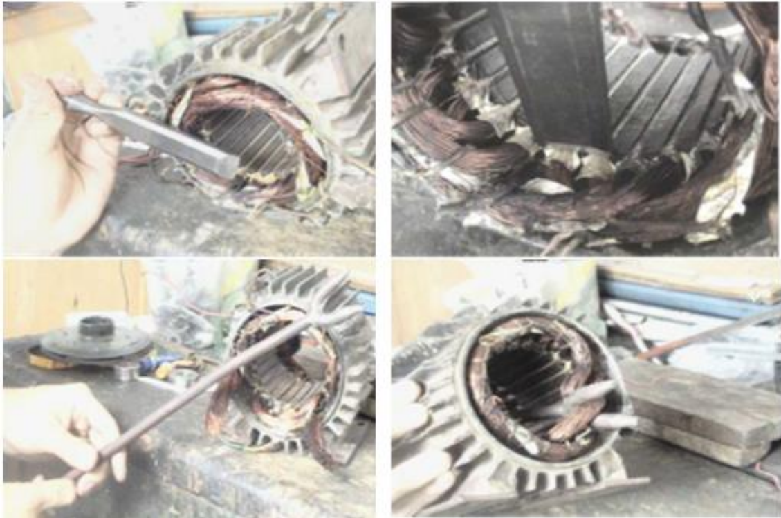
Ilustración 14. Extraer el devanado viejo con formón y utensilios manuales. Fuente: [23]
