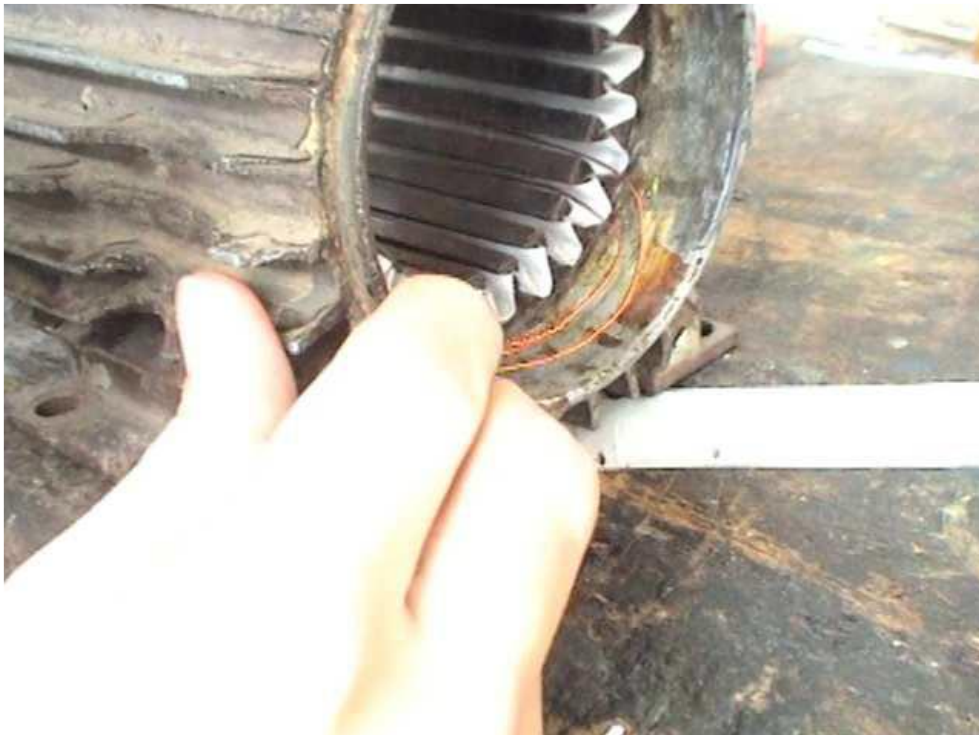
Ilustración 19. Bobinas unitarias para moldes. Fuente: [23].
