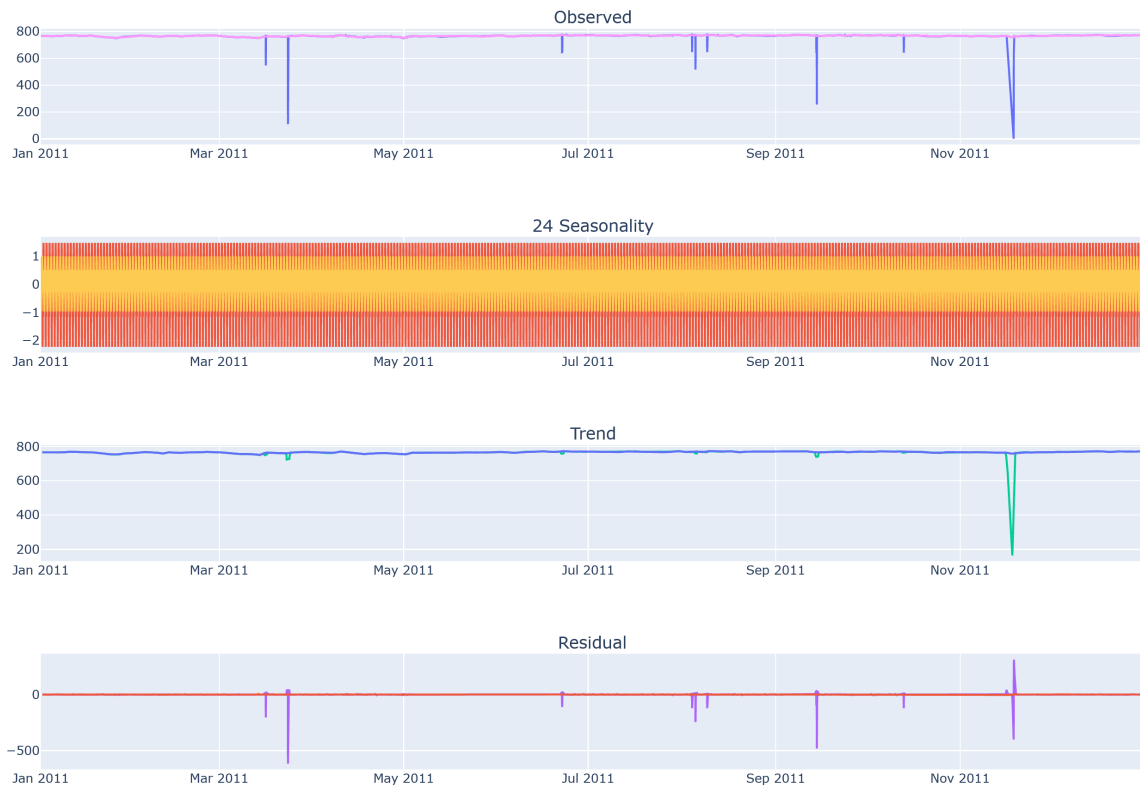
Figura 4.12: Suavizado de anomalías utilizando residuos STL e IF sobre BP.
