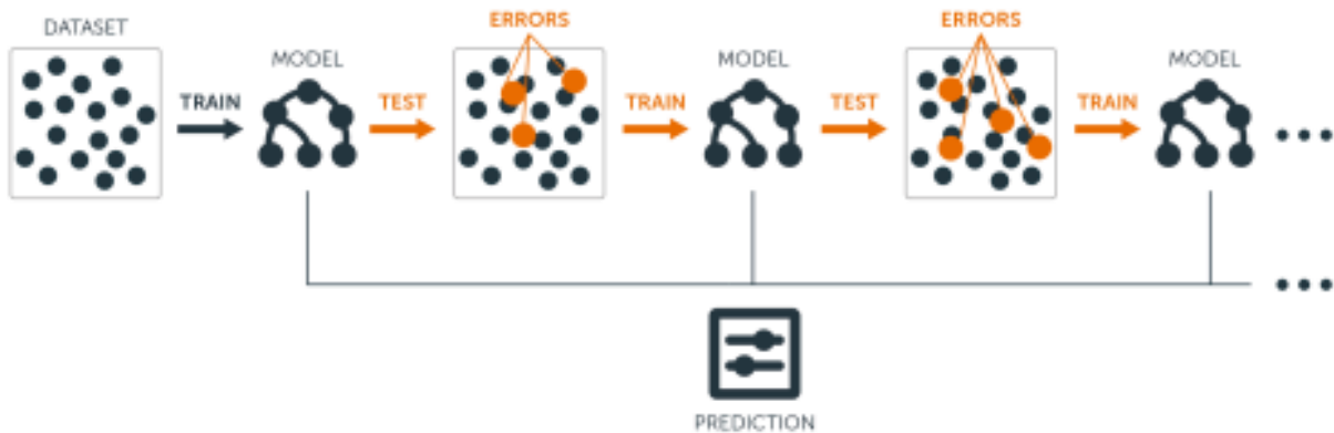
Figura 2.4: Secuencialidad del proceso de boosting [18]
