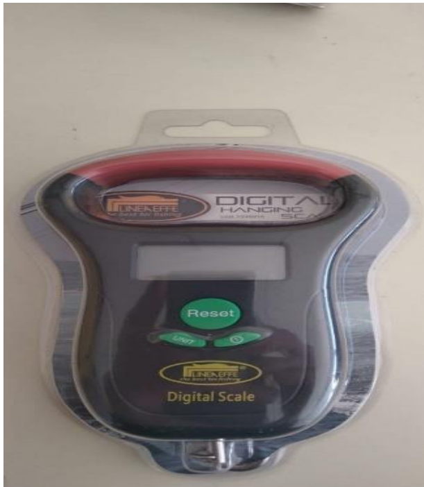
Figura 12: pesa digital de mano utilizada en el estudio, marca LINEAEFEE 25 Kg. Fuente: imagen propia.
