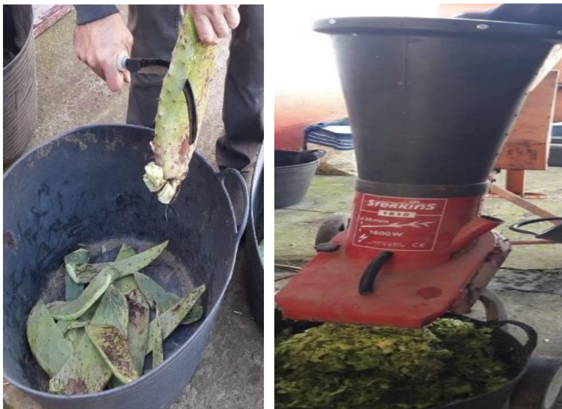
Figura 10 (Izquierda): picado manual de las pencas antes de pasarlas por la trituradora. Fuente: imagen propia / Figura 11 (Derecha): picadora utilizada en el proceso, marca Sterkins, modelo 1810, potencia 1600 W, voltaje 230/240 V. Fuente: imagen propia
