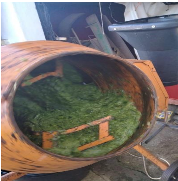
Figura 13: hormigonera utilizada en el ensayo, marca ALKO KOBER, modelo AL-KO TOP 1401, potencia 400 W, voltaje 220V, amperaje 1,9A. Fuente: imagen propia
