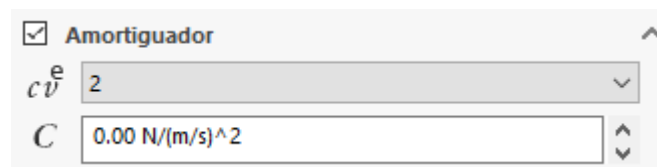
Figura 1.23 Parámetros de amortiguación del resorte
