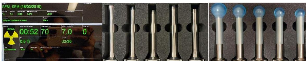
Imágenes 2: a) software RadControl II. b) Aplicadores esféricos y cónicos.
