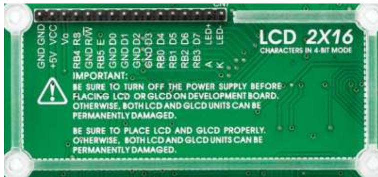
Figura 3.7. Pines de la placa para conectar la pantalla LCD.
