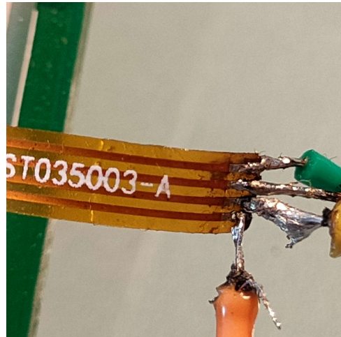
Figura 2.3. Soldadura de estaño.
