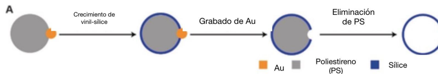
Figura 11. Esquema del proceso de fabricación de la abertura hueca de las nanobotellas. Reproducida con modificaciones con permiso de (Qiu et al., 2019).
