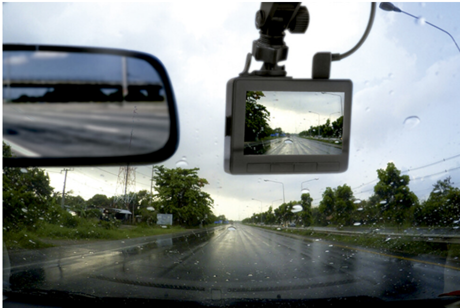
Figura 78. Sistema Dashcam implementado en un vehículo. [22]
