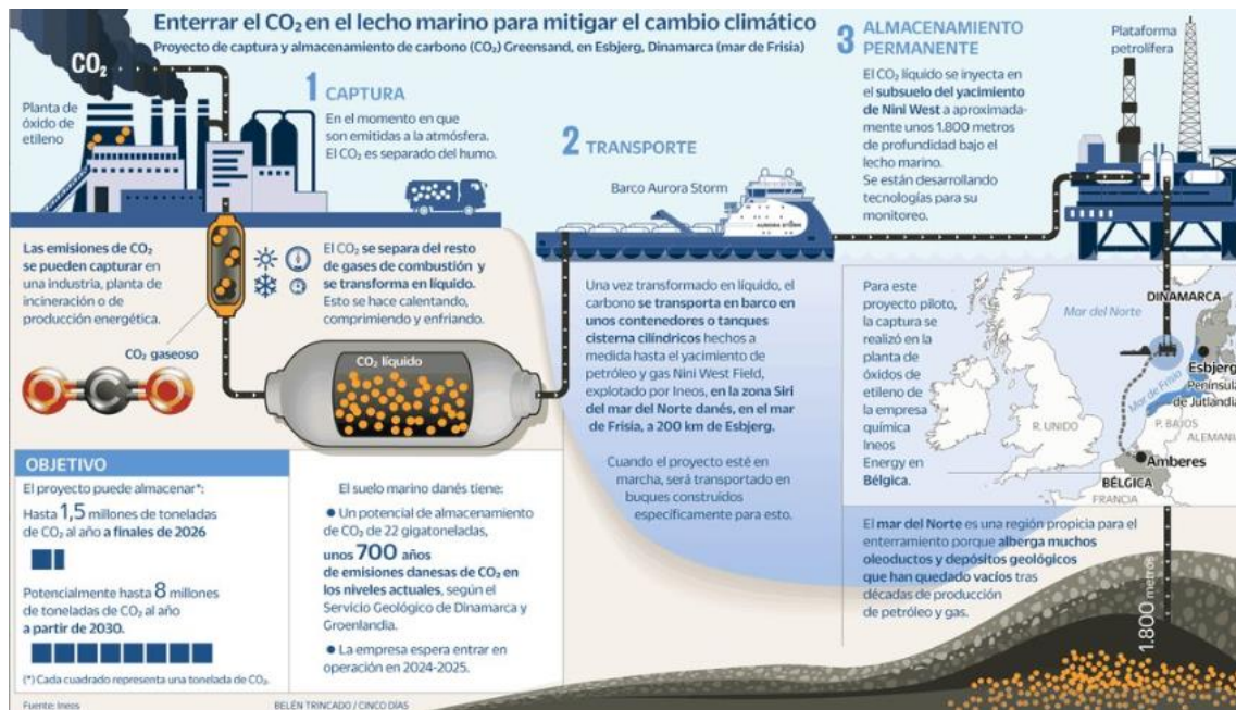
Figura 11. Esquema del proyecto de CCS Greensand (Dinamarca) (Fuente: CincoDías).
