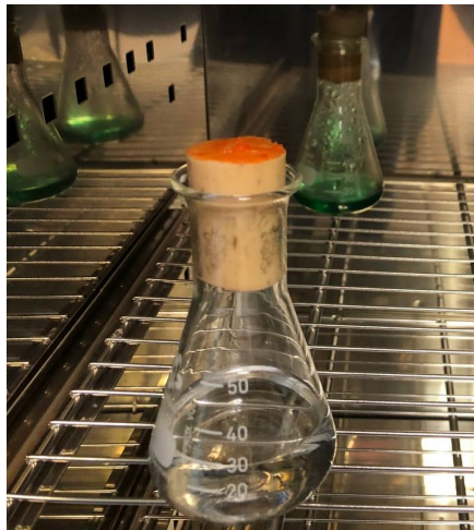
Figura 9: Disolución sellada con un tapón, perforado, dentro de la estufa a 85°C.
