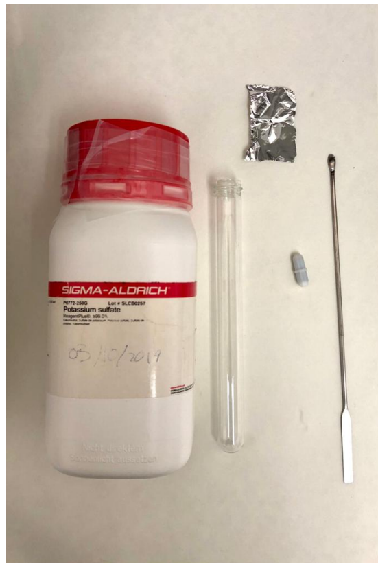
Figura 26: Material empleado para realizar las curvas de solubilidad. Consta de un tubo de ensayo, un iman, papel aluminio para tapar el tubo (evitando así la evaporación), cucharilla de metal y el compuesto correspondiente en cada caso.
