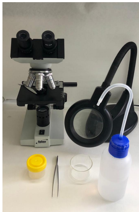
Figura 12: Material empleado para la extracción de los cristales. Se emplea agua bidestilada, pinzas de metal, papel de filtro, lupa, microscopio y un recipiente para almacenar y clasificar las muestras.
