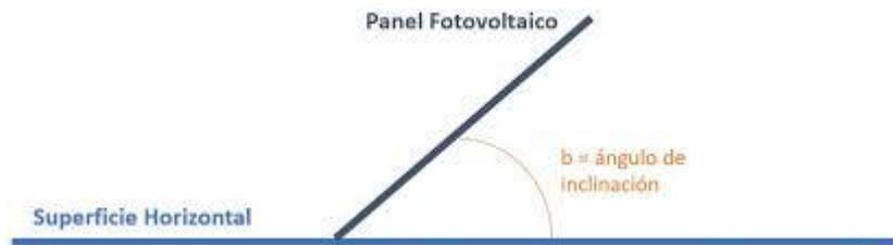
Imagen 2.1.2. Ángulo de inclinación panel solar
