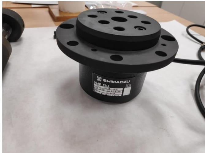
*Figura 30 – Célula de carga de 5 kN con el plato de sujeción instalado en ella*
