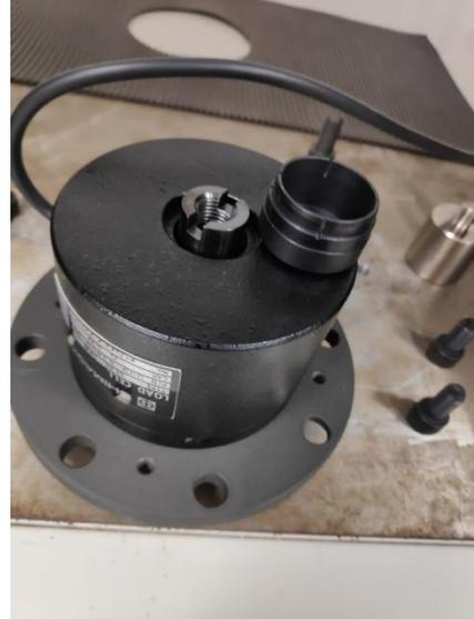
*Figura 33b – Célula de carga de 5 kN sin el cabezal protector*
