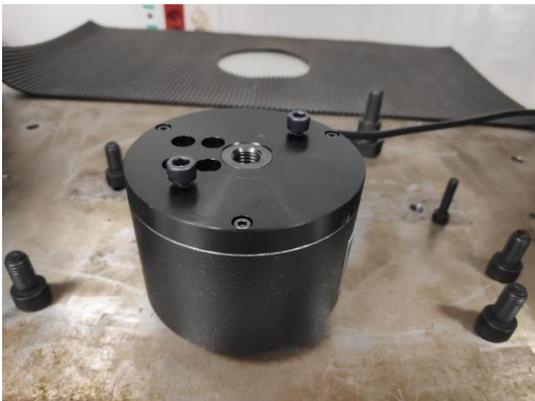
*Figura 29a – Célula de carga de 5 kN con los tornillos de unión al plato de sujeción instalados*
