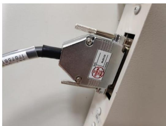
**NOTA IMPORTANTE: No se deben mezclar los cables de cada célula, el software del ordenador reconocerá que está conectada ÚNICAMENTE la célula a la que pertenece el cable**
