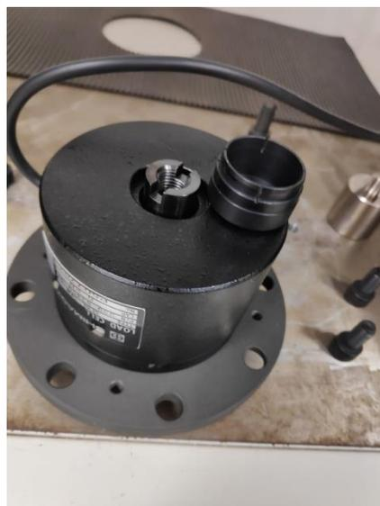
**Paso 5: Colocar el adaptador de accesorios y ajustar el tornillo una vez colocado el accesorio**
