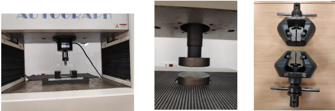
Figura 2 – Accesorios de la máquina universal para flexión, compresión y tracción respectivamente
