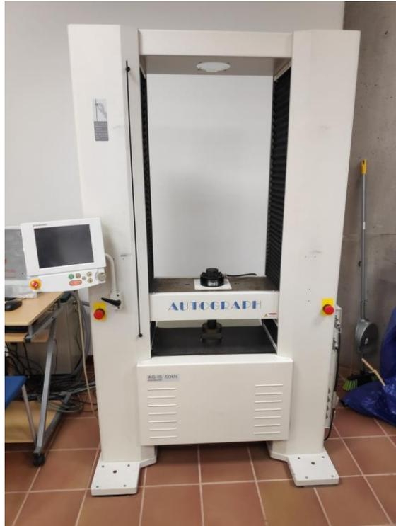
*Figura 1 – Máquina universal de ensayos mecánicos SHIMADZU AUTOGRAPH AG-IS*
