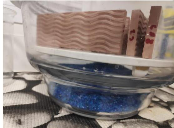
*Figura 12b – Gel de Sílice deshumidificador en grano en el interior del desecador*
