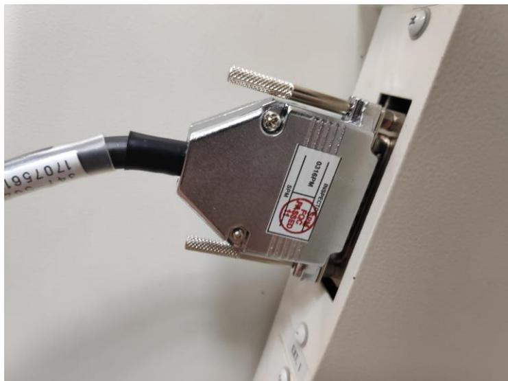
*Figura 34 – Cable de la célula de carga de 5 kN conectado a la máquina universal de ensayos*
