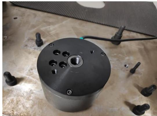
**Paso 2: Acoplar y atornillar el disco a la célula de la forma en la que se indica en las imágenes**
