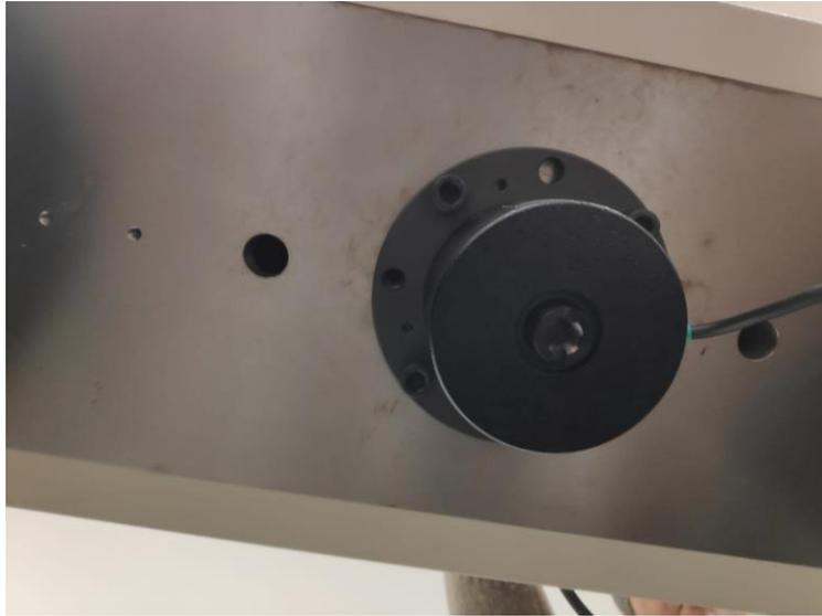
*Figura 31 – Vista inferior de la Célula de Carga de 5kN instalada*
