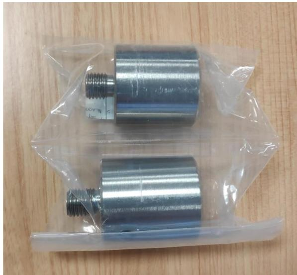
*Figura 35 – Adaptadores de la célula de carga de 5 kN para flexión y compresión (inferior y superior respectivamente en la imagen)*
