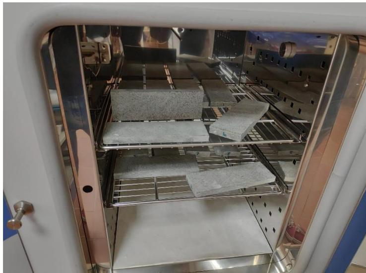
*Figura 18 – Probetas de piedra colocadas en la estufa de secado*
