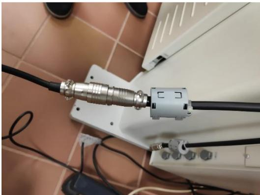
*Figura 27a – Conexión entre célula de carga y máquina universal de ensayos*
