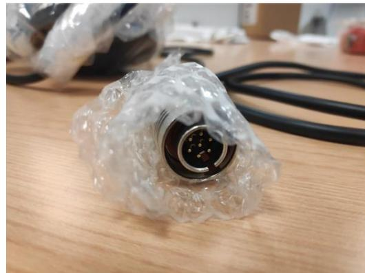
*Figura 27b – Tipo de conector de 7 pines empleado para el cable de las células de carga*
