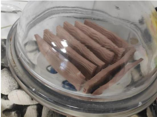
*Figura 12a – Probetas de cerámica enfriándose en el desecador*
