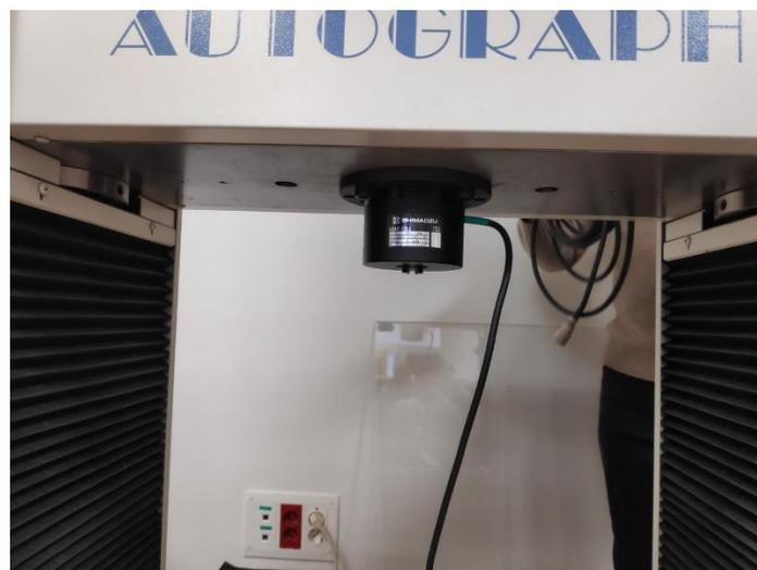
*Figura 32 – Célula de Carga de 5 kN después de su instalación*
