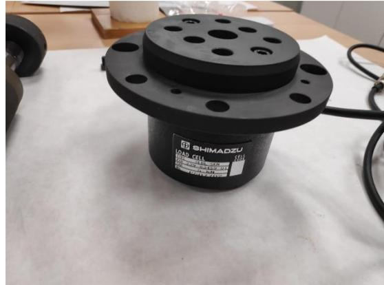
*Figura 3b – Célula de carga de 5 kN*
