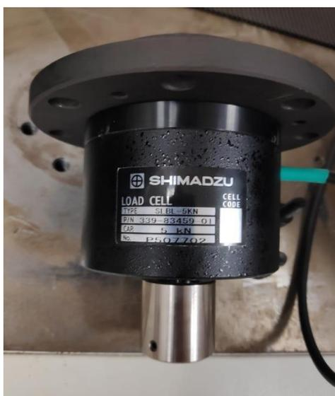
*Figura 36 – Célula de Carga de 5 kN con el adaptador a flexión instalado*
