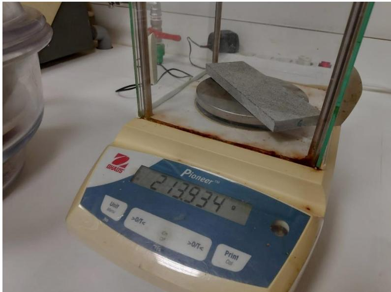
*Figura 17 – Probeta de piedra siendo pesada*
