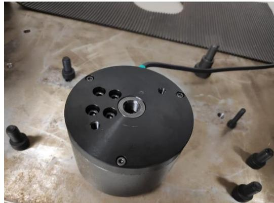
*Figura 29b – Célula de carga de 5 kN con todos los tornillos retirados*
