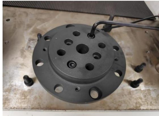
**Paso 3: Ajustar el tornillo central del plato y atornillar el plato de sujeción a la parte inferior del brazo de la máquina universal de ensayos**
