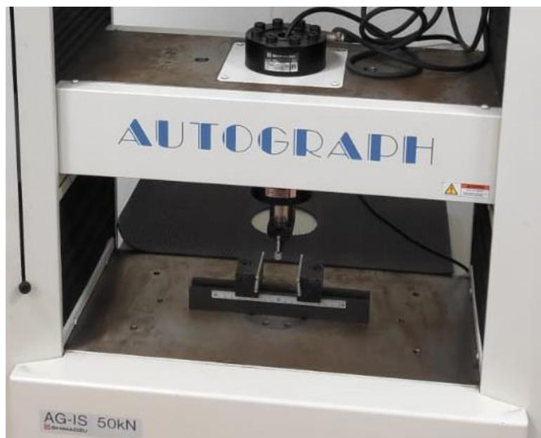
*Figura 25 – Máquina de ensayo universal con ambas células de carga instaladas*
