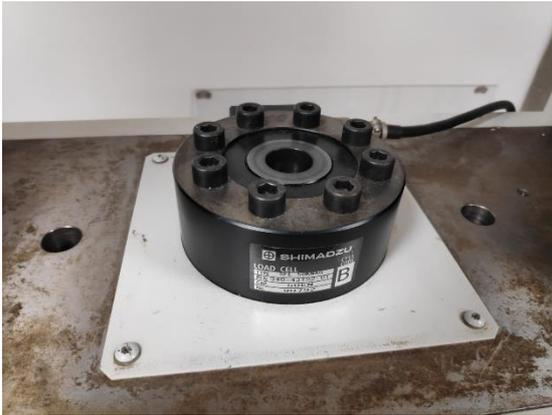
*Figura 3a – Célula de carga de 50 kN*
