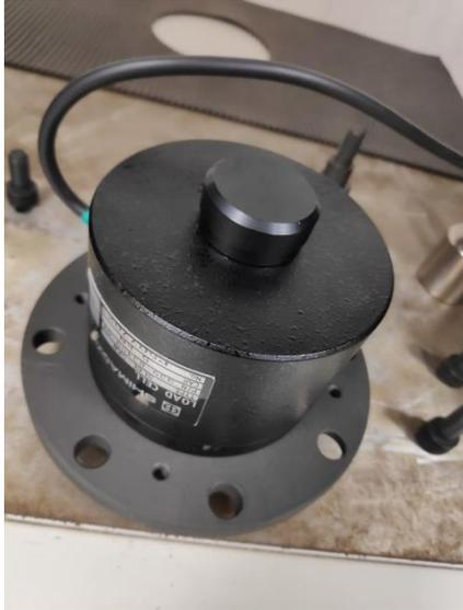
*Figura 33a – Célula de carga de 5 kN con el cabezal protector*
