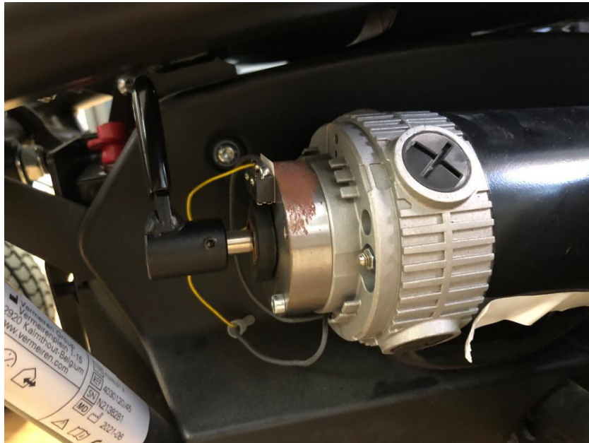
Figura 2. Freno del motor izquierdo junto a la palanca de desarme manual.
