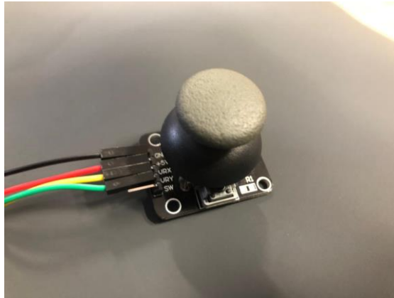
Figura 12. Joystick analógico utilizado para recibir inputs del usuario
