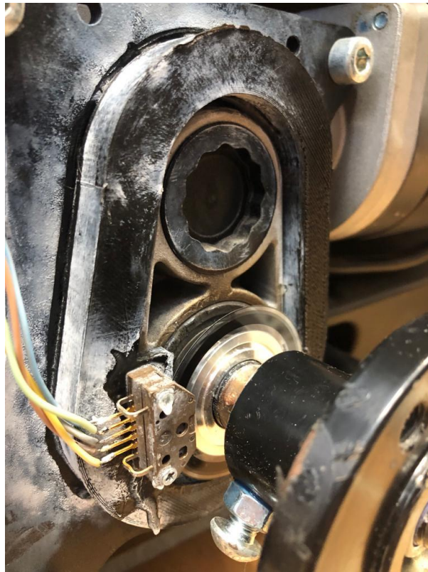
Figura 11. Encoder instalado en la pieza de sujeción diseñada
