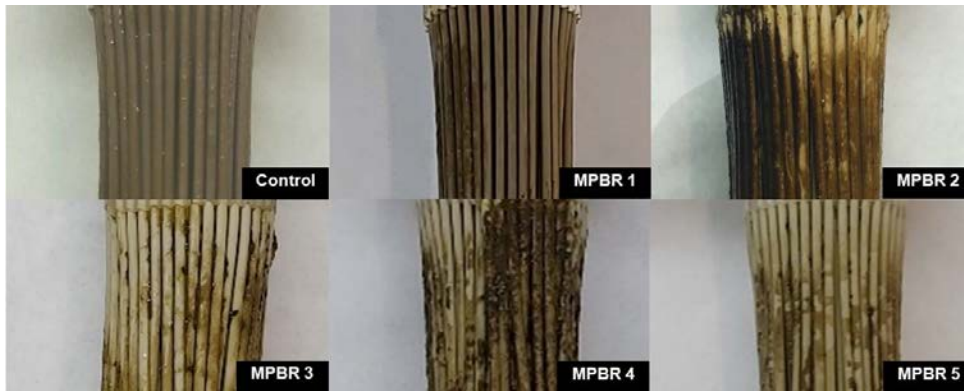
Figura 7.8. Fotografías de las membranas al final de los ensayos de larga duración. Influyente secundario. Control: HRT = 0,75 días, SRT = 40 días; MPBR 1: HRT = 0,75 días, SRT = 20 días; MPBR 2: HRT = 0,75 días, SRT = 40 días; MPBR 3: HRT = 0,75 días, SRT = 80 días; MPBR 4: HRT = 2 días, SRT = 80 días; MPBR 5: HRT = 5 días, SRT = 80 días.
