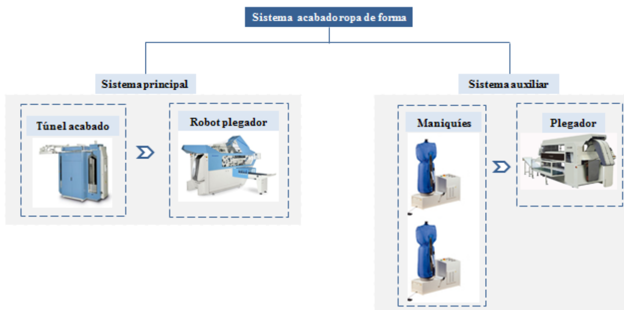
Figura 51. Esquema sistema acabado ropa de forma.
