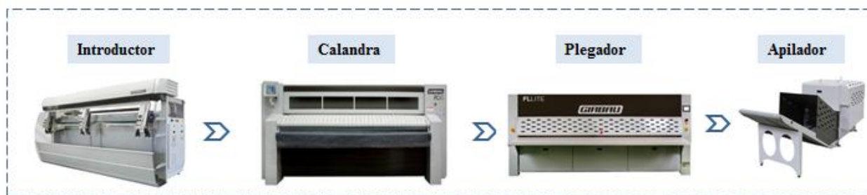
Figura 38. Esquema funcionamiento sistema de acabado ropa lisa.
