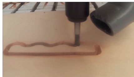
Plano detalle del fresado del mango de la estructura de pino
