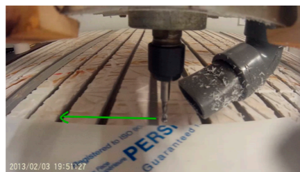
Plano detalle de corte del primer metacrilato
