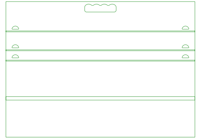
Chapa DM (vista delantera) Chapa DM de 3mm
