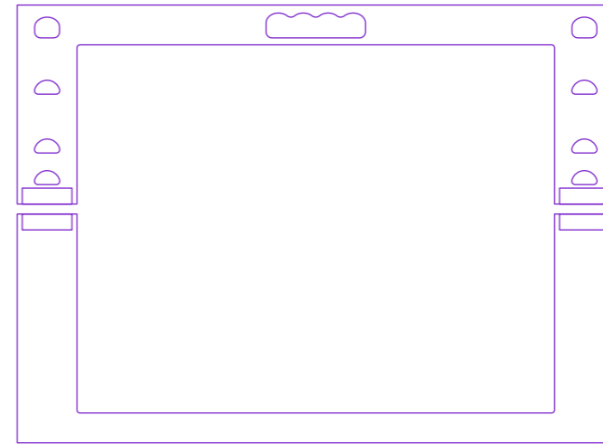
Estructura de pino (vista trasera) Tablero marino contrachapado fenólico 10mm
