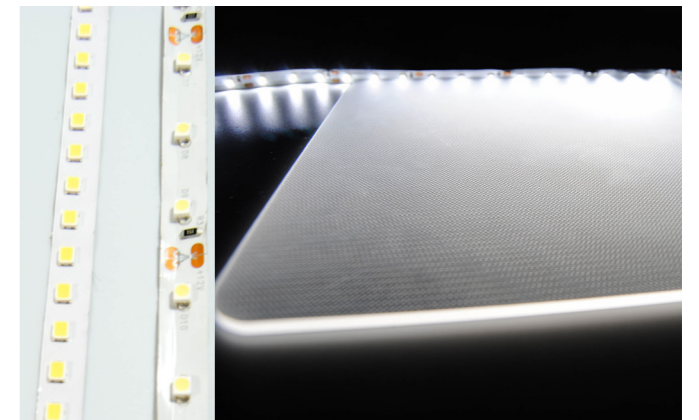
Fig.53, 54. (de izquierda a derecha) metacrilato de la lámpara ultra fina y LED de 60 y 120 unidades por metro.
