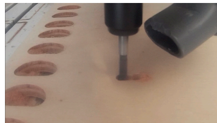
Plano detalle del fresado de los topes de la estructura de pino
