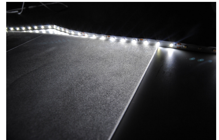
Fig 56. Refracción de la luz con papel vegetal
