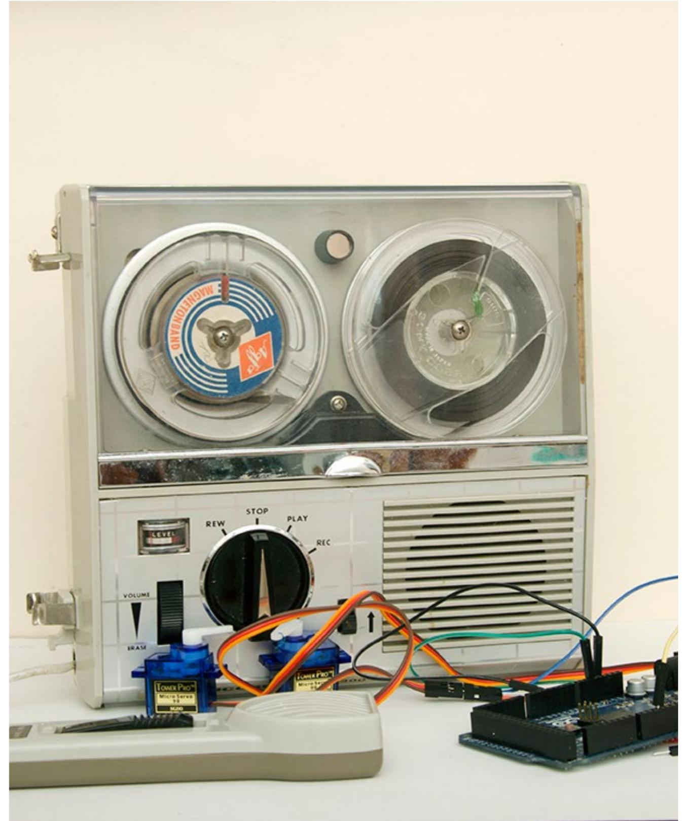
> Intervención en selector de magnetófono con servomotor.
