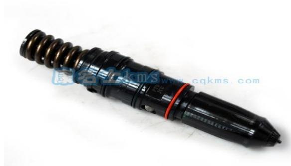
Ilustración 20: Inyector
