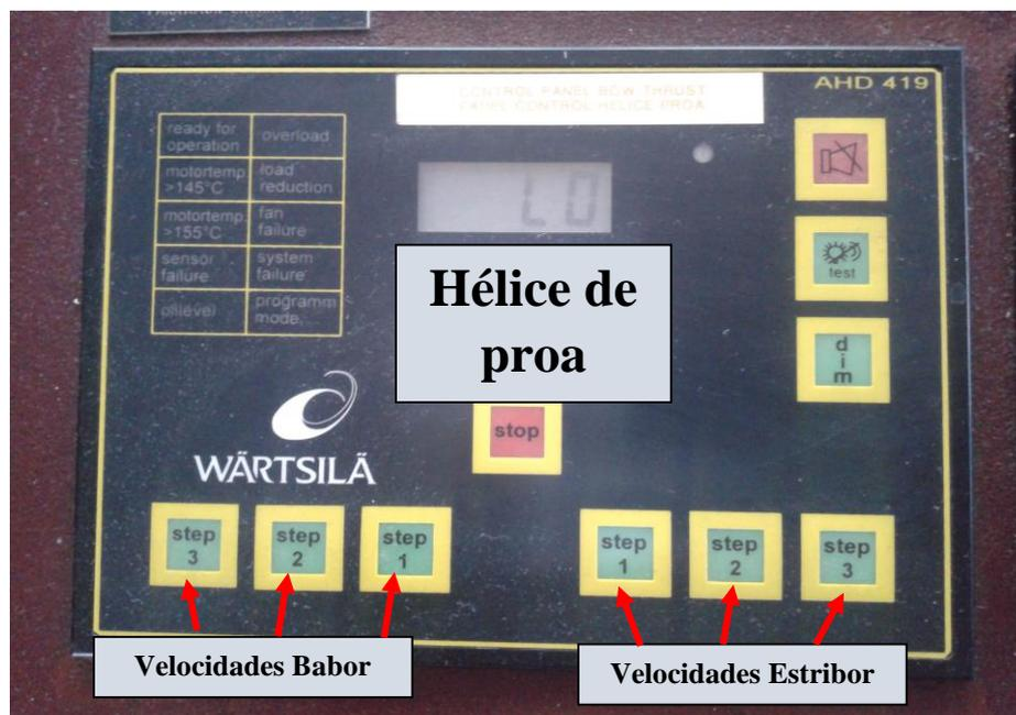
Ilustración 34: Control de la hélice de proa desde el puente
