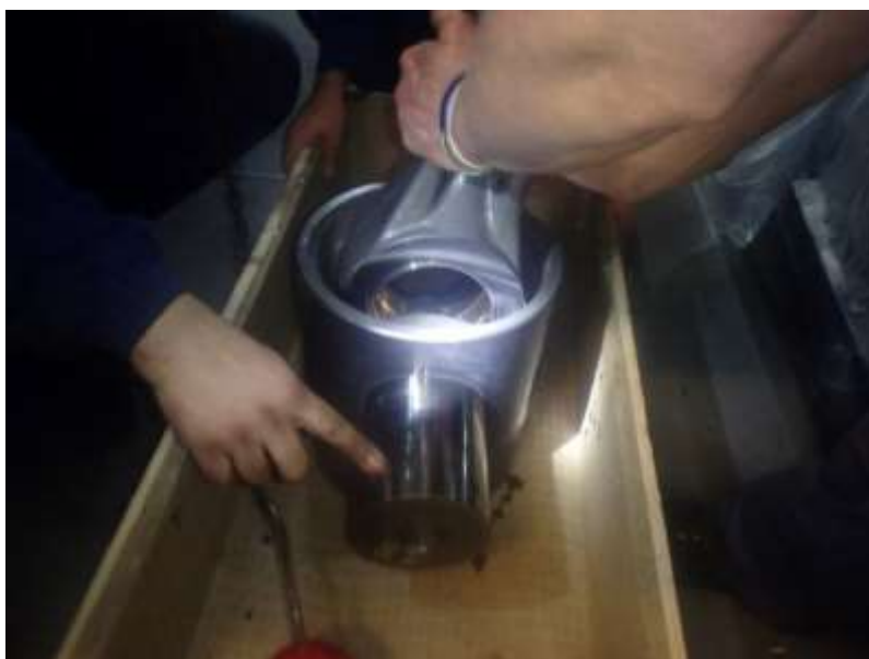
Ilustración 90: Unión de un pistón con la biela desde otra perspectiva
