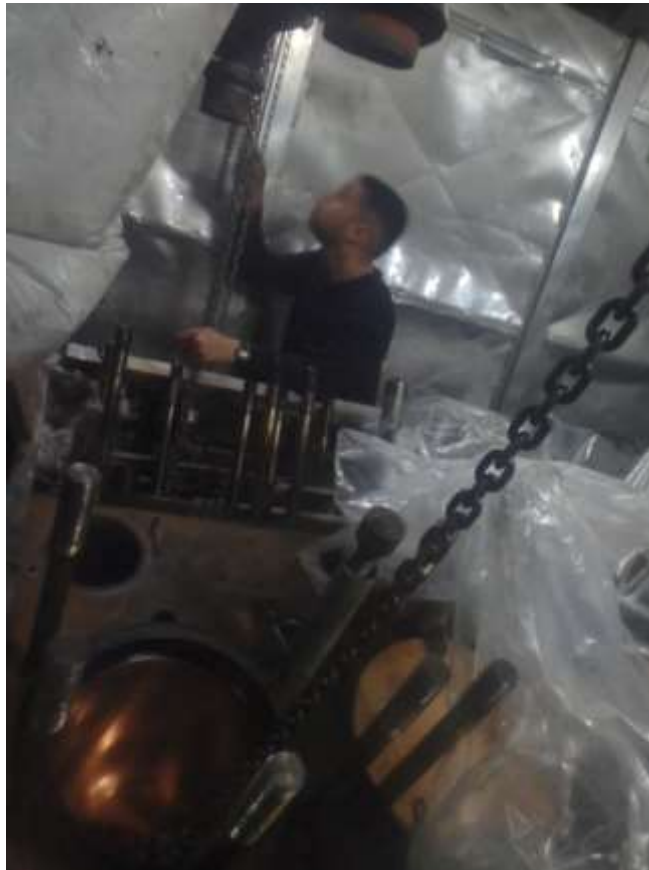
Ilustración 81: Operarios levantando el cigüeñal con la ayuda de dos tecles
