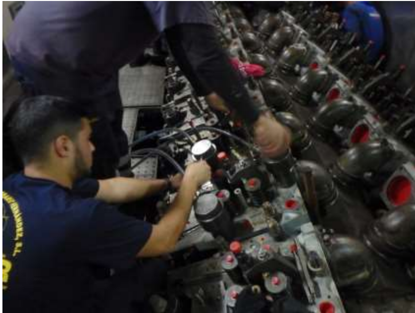
Ilustración 93: Operarios realizando el apriete de las culatas
