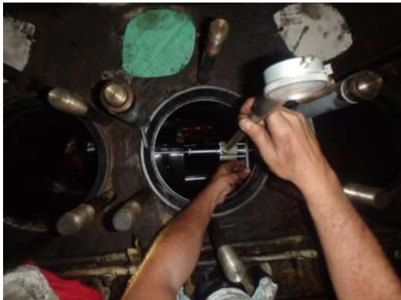
Ilustración 75: Medición de la camisa
