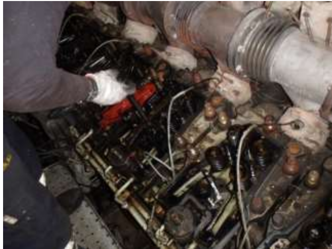
Ilustración 65: Operario retirando balancines y vista de la toma de temperaturas de escape
