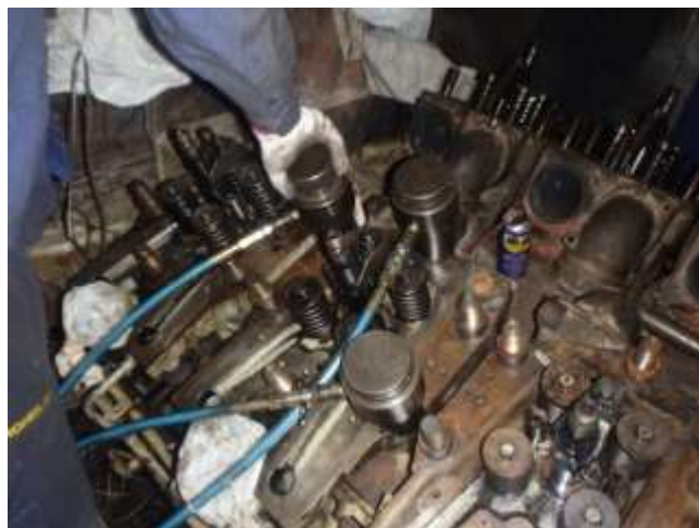
Ilustración 66: Operario colocando los elementos para aflojar las tuercas de la culata
