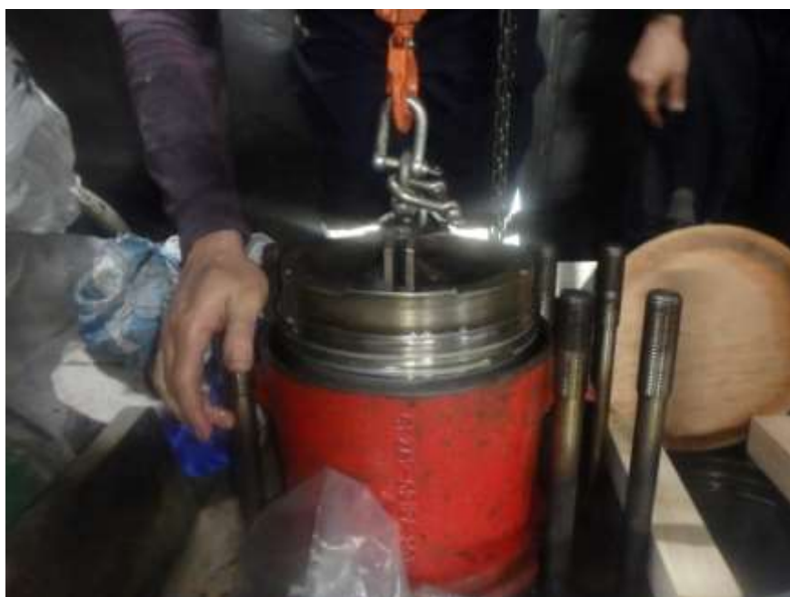
Ilustración 87: Colocación del pistón con ayuda de un útil
