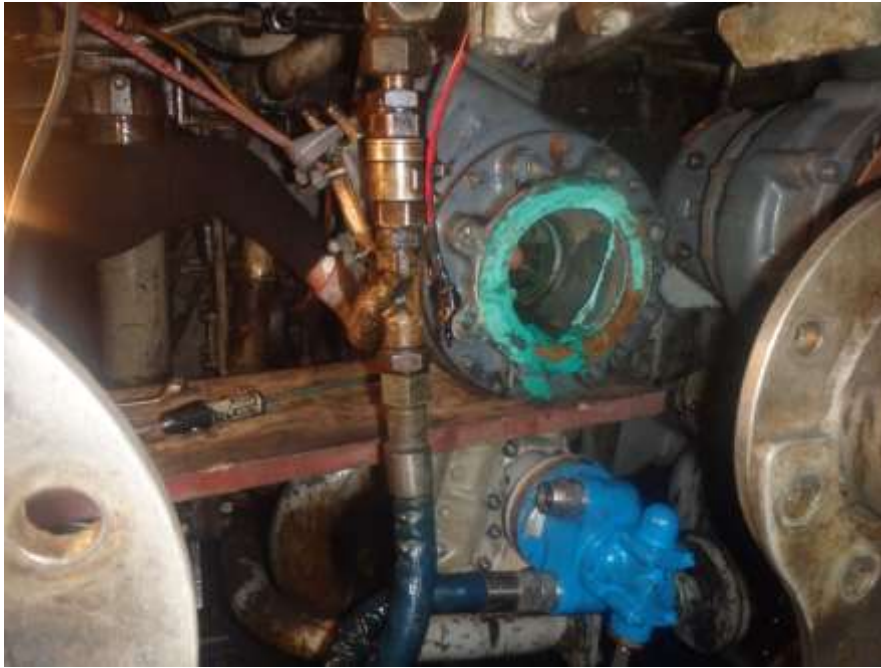
Ilustración 58: Bomba de combustible en azul
