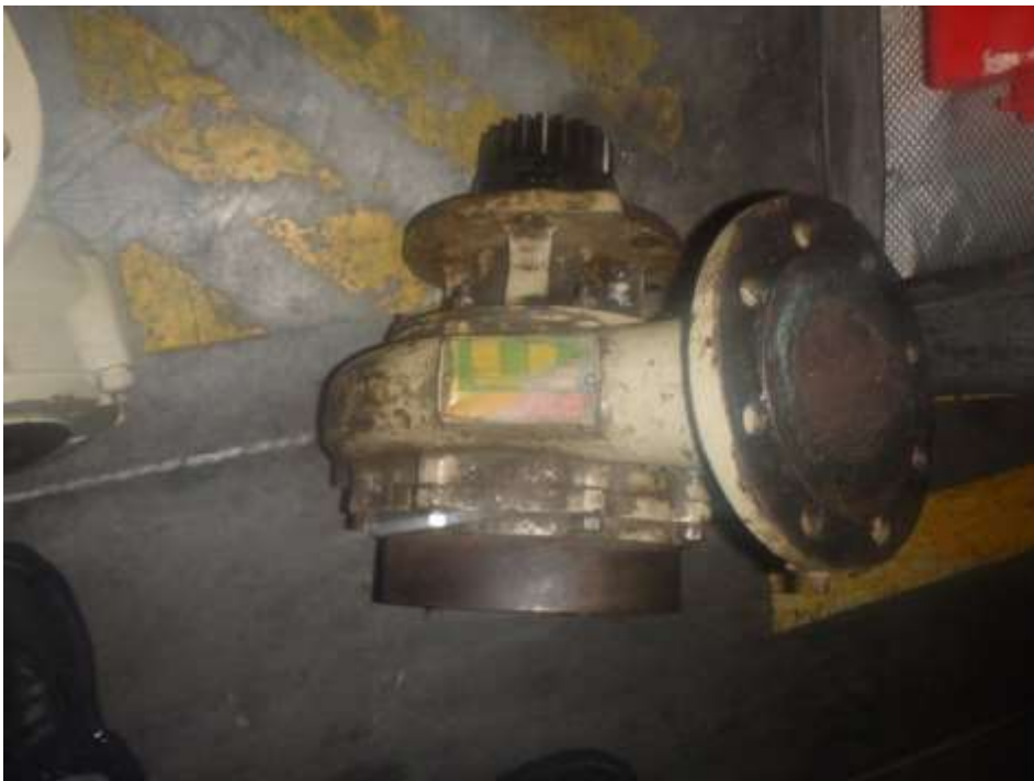
Ilustración 55: Distinta perspectiva bomba agua dulce sacada del motor.
