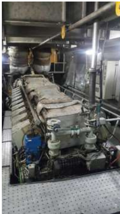
Ilustración 52: Motor principal del bonanza Express.
