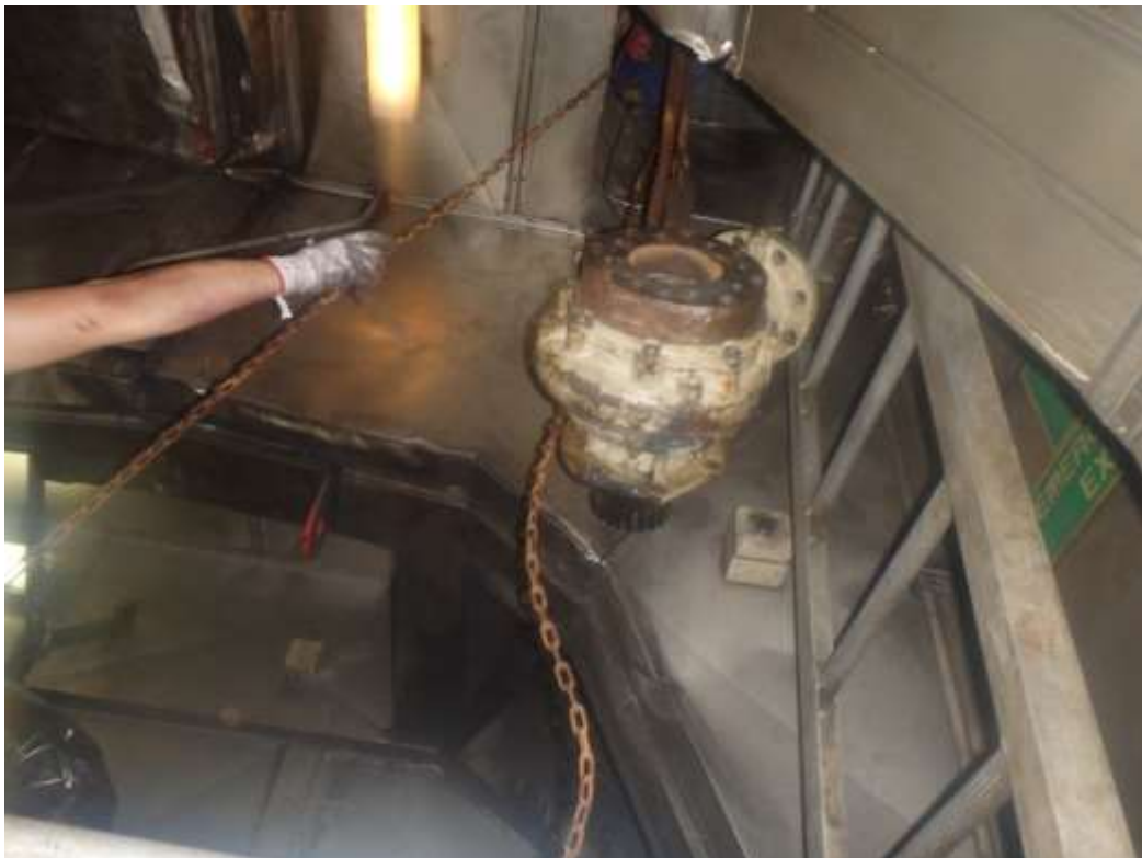
Ilustración 53: Izado bomba de agua dulce
