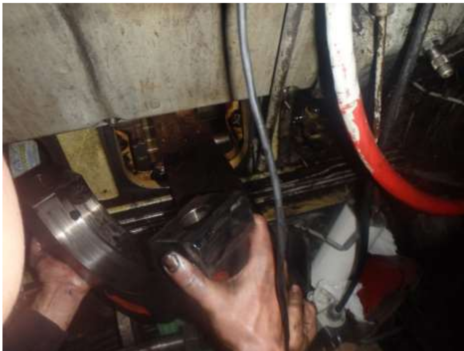
Ilustración 84: Colocación de la taba del cojinete de bancada
