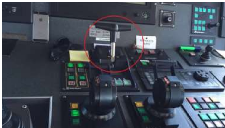
Ilustración 32: Mandos del Booster en el puente
