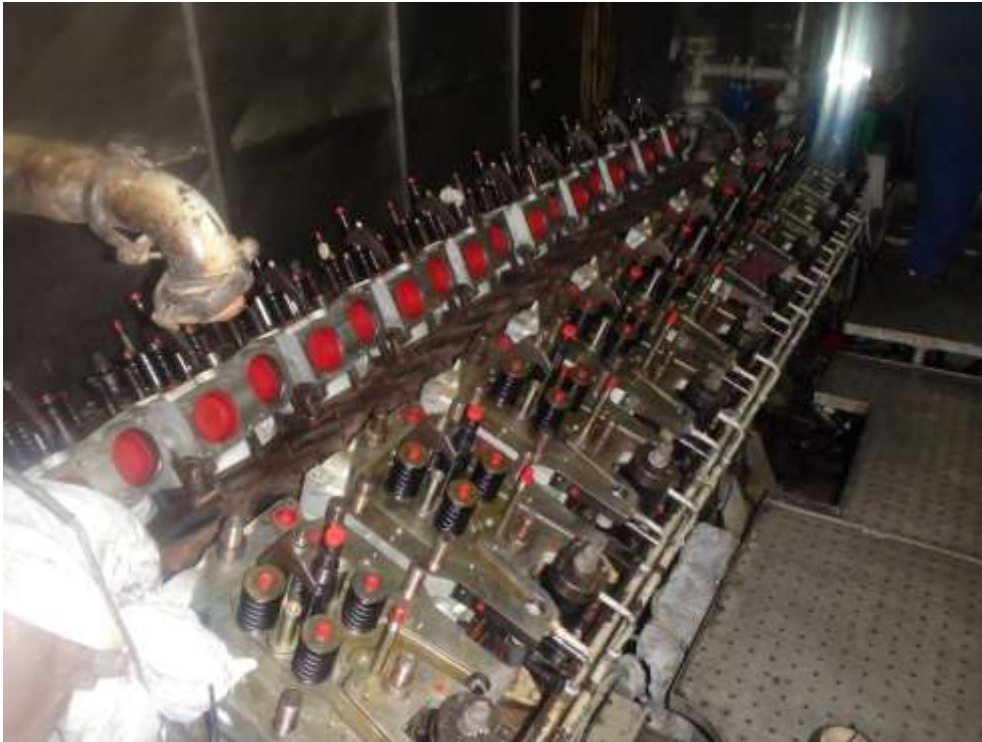
Ilustración 92: Vista del motor con las culatas y los inyectores nuevos colocados
