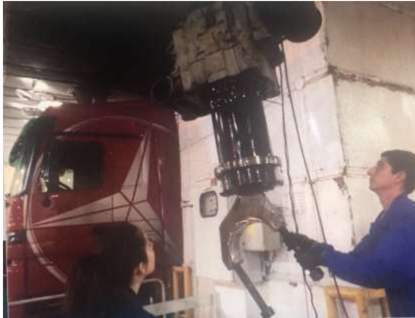
Ilustración 98: Unidad enganchada al tecele
