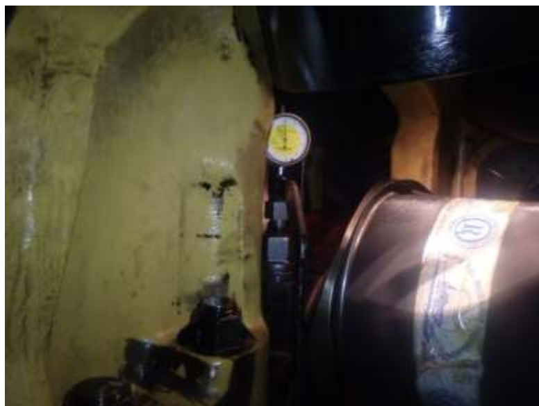
Ilustración 85: Apriete de los cojinetes de bancada.
