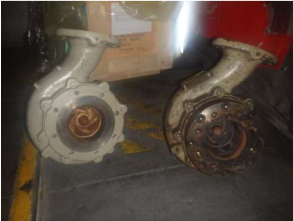
Ilustración 54: Comparación bomba agua dulce nueva y vieja.
