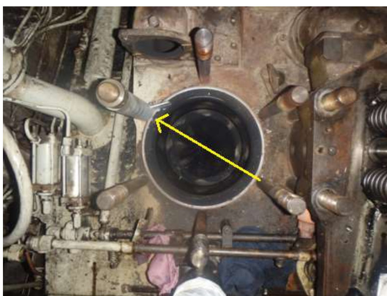
Ilustración 71: Vista del útil para evitar que la camisa se salga del sitio
