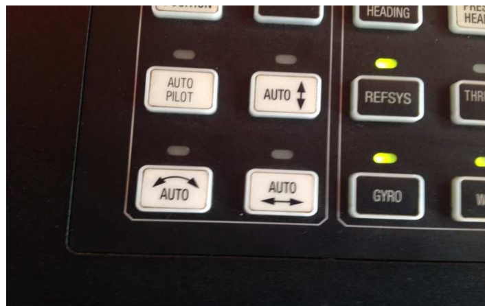
Fig. 3.69 Los tres grados de libertad controlables, surge, sway y yaw. Kongsberg M.Cervantes [5]
