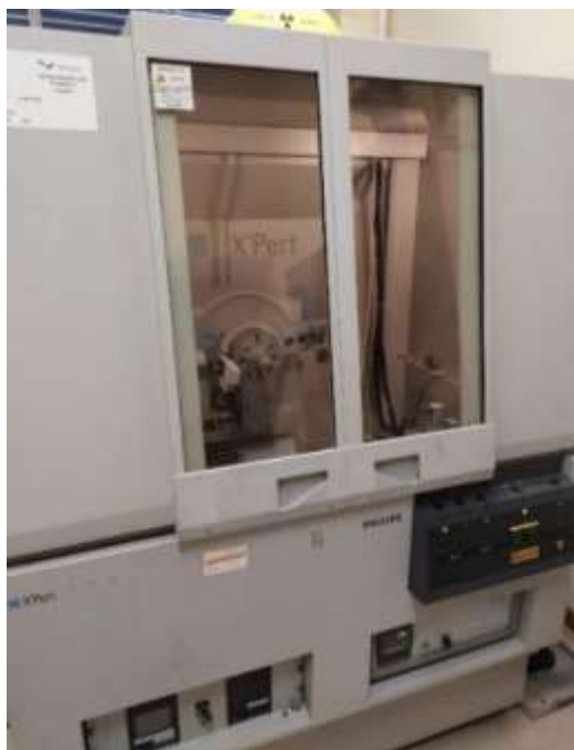
Figura 3.2. Difractómetro PANalytical X'PERT-Pro.
