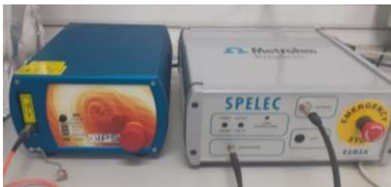
Figura 3.3. Equipo de espectroscopía Raman.
