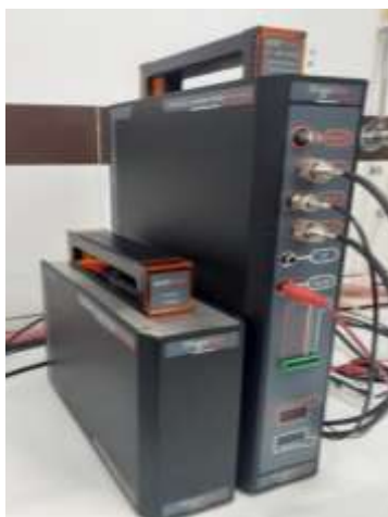
Figura 3.9. Potenciostato-galvanostato OrigaFlex – OGF01A.
