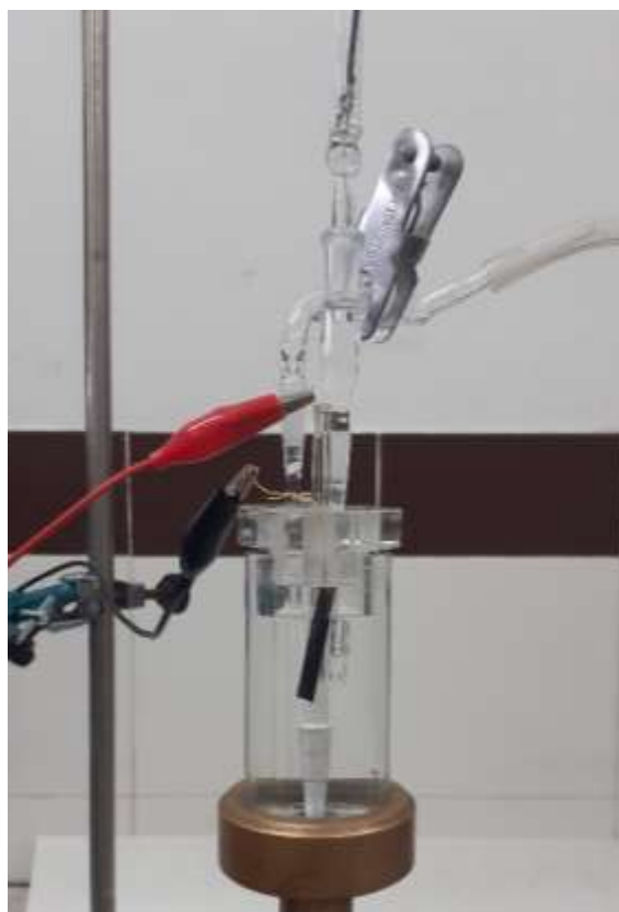
Figura 3.13. Celda electroquímica en la que se realizan las medidas DEMS
