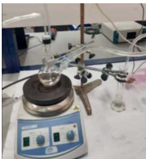
Figura 3.15. Sistema de atmósfera inerte para la síntesis del calcogenuro de níquel dopado con Se.
