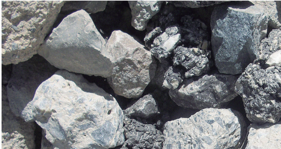
Figura 1.12. Material drenante grueso
