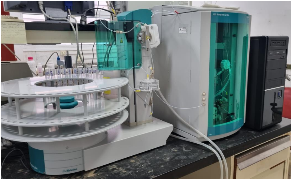
Figura 10: Equipo de Cromatografía Iónica Methrom 930 Compact IC Flex con un detector de conductividad 850 Profic y equipado con un sistema para la supresión química del eluato MSM (Methrom Supressor Module)
