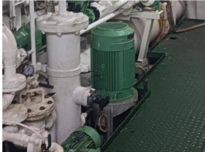
Ilustración 3. Bomba de lastre. Fuente: Elaboración propia
