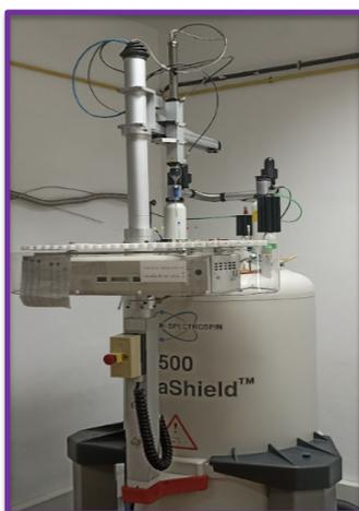
FIGURA 10. Equipo de RMN BRUKER® AVANCE 500 MHz.
