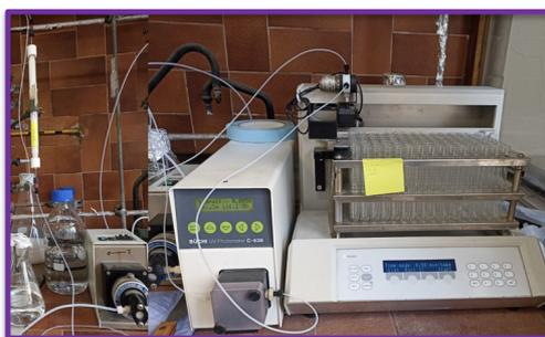
**FIGURA 7.** Sistema de cromatografía de media presión
