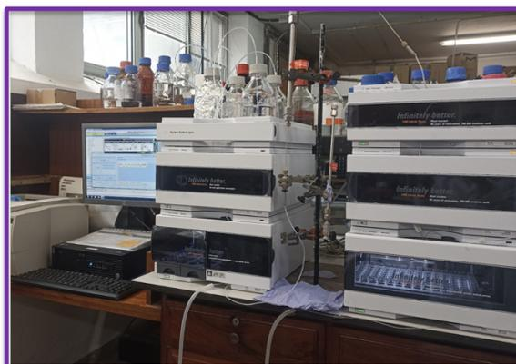
**FIGURA 8.** Equipo de HPLC Agilent Technologies Serie 1200.
