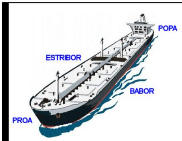
Figura 3. Partes de un buque mercante. Fuente: Ingeniero Marino
