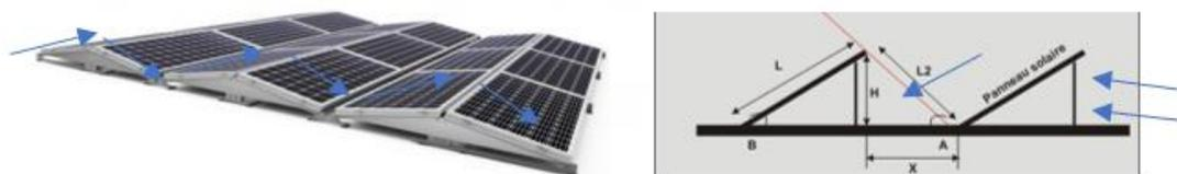
Ilustración 8: Imagen demostrativa de la mejora de la estabilidad de las placas con respecto al viento. Fuente: (Insa, 2019)
