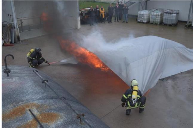
Ilustración 19: Imagen donde se realiza una demostración de la sofocación de un vehículo con manta ignífuga. Fuente: (Motorpasion, s.f.)
