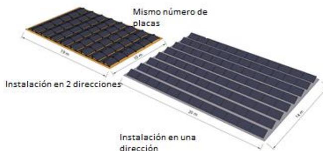
Ilustración 7: Ejemplo del ahorro de espacio al usar la orientación bidireccional. Fuente: (Insa, 2019)
