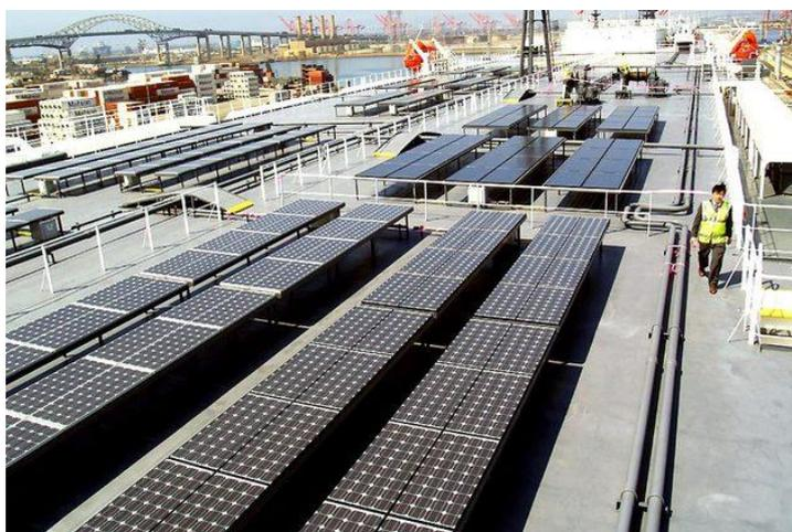
*Ilustración 1: Imagen donde se puede ver las placas solares instaladas en el buque Auriga Leader.
