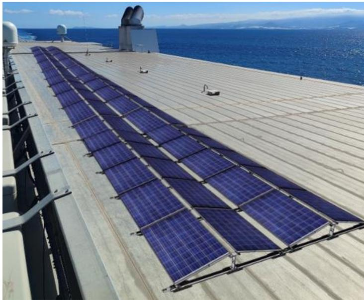
*Ilustración 4: Simulación de la distribución de las placas en una de las bandas del buque
