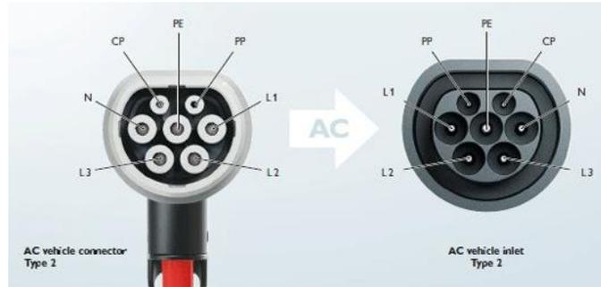
Ilustración 15: Imagen de enchufe tipo 2 Fuente: (Lugenergy, s.f.)
