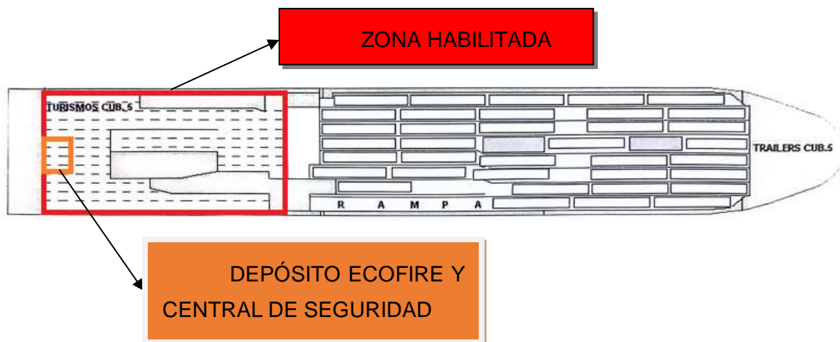
Ilustración 12. Zona habilitada y colocación del depósito ECOFIRE. Fuente: Elaboración propia
