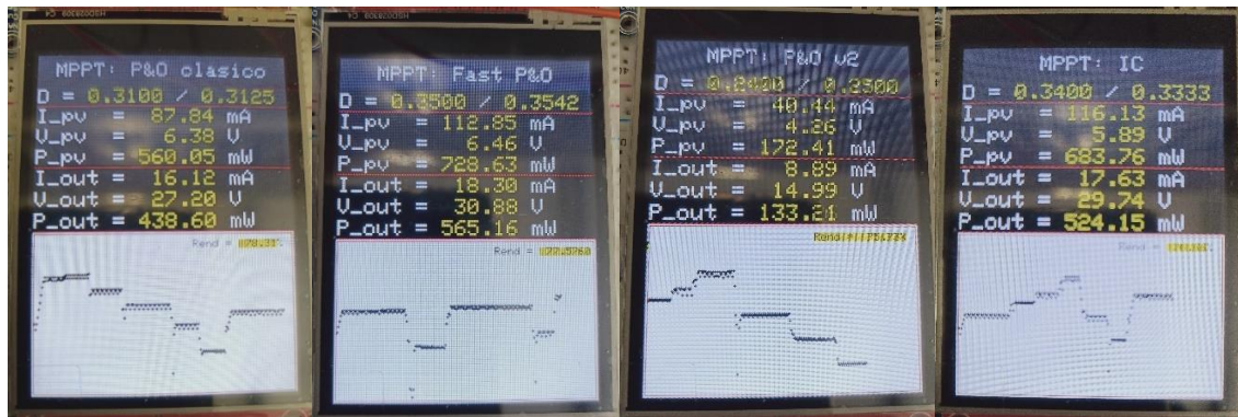
figura 10.2. Ejemplos de visualizaciones de resultados con los cuatro algoritmos MPPT implementados en el modelo a escala reducida variando la fuente de irradiancia aleatoriamente. Fuente: Elaboración propia.
