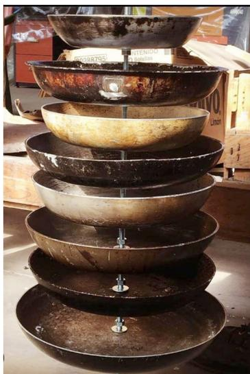
Figura 9. Fijación de sartenes en una barra roscada.
