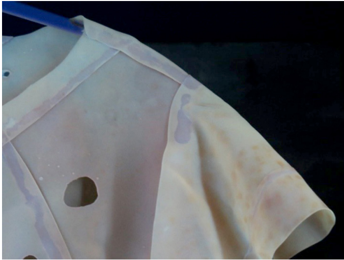
Fig. 8. Detalle del ataque biológico en el traje, bajo fluorescencia UV. Fuente propia.
