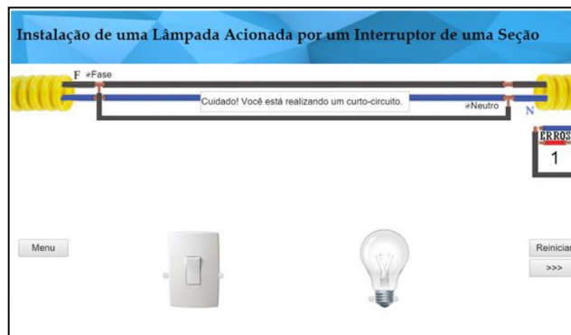
Fig. 6. Erro: Condutor fase ligado diretamente com o condutor neutro.
