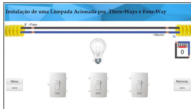
Fig. 17. Fase 7 do jogo de Instalações Elétricas.
