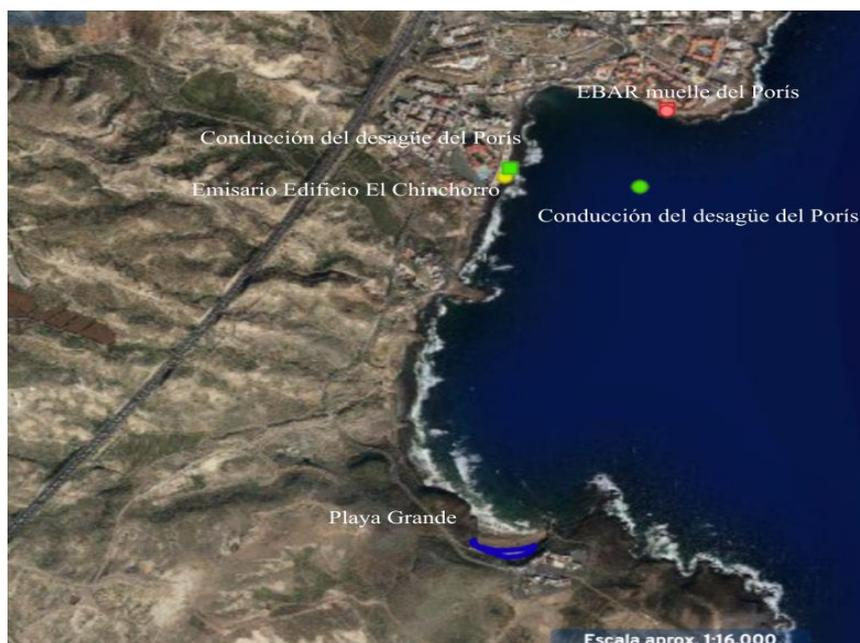
**Figura 4.7.** Localización de los emisarios submarinos próximos a Playa Grande: EBAR muelle del Porís, conducción del desagüe del Porís y Emisario Edificio El Chinchorro (105).
