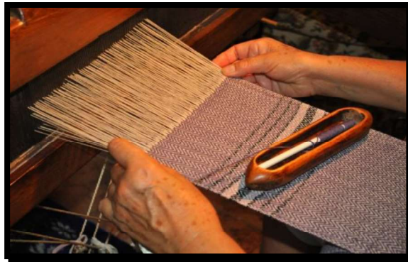
Foto: Detalle de telar donde se aprecia la lanzadera y el novelo.
