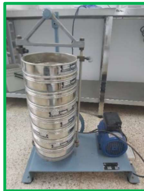
Foto 18. Nido de tamices y contenido tamizado en cada uno de ellos.
