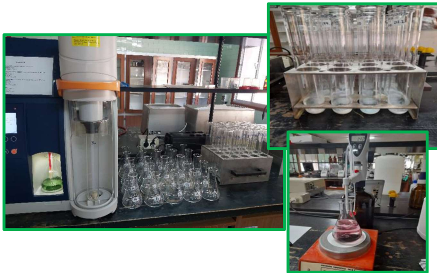
Foto 23. Tubos de digestión y valoración ácido - base de nitrógeno en suelos.
