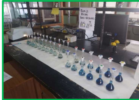
Foto 22. Método Olsen para la determinación de fósforo asimilable.
