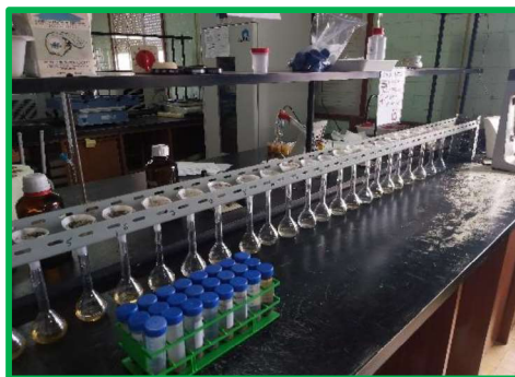
Foto 21. Extracción de cationes para su posterior lectura en espectrofotometría de absorción atómica.
