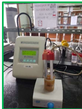
Foto 20. Momento de la lectura de conductividad eléctrica en el conductímetro.
