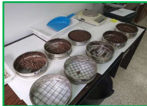
Foto 18. Nido de tamices y contenido tamizado en cada uno de ellos.
