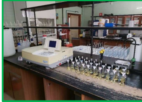
Foto 26. Método molibdovanadato para el análisis de fósforo en foliares.
