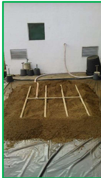
Foto 8. Proceso de esterilización del sustrato en caldera de vapor Ygnis 60/4.
