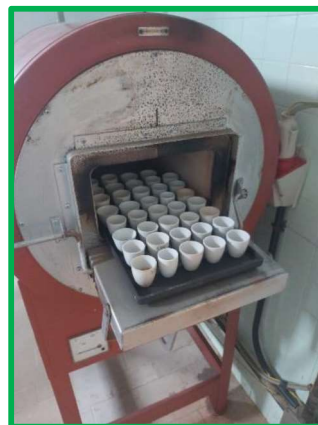
Foto 25. Molino y mufla con las muestras de foliares para ser calcinadas.
