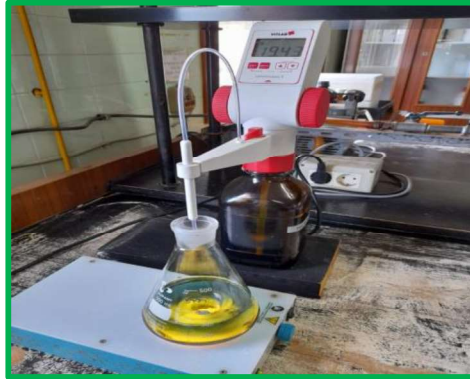
Foto 24. Valoración oxidación- reducción para el cálculo de la materia orgánica oxidable.
