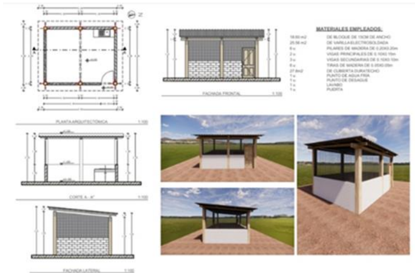
Figura 5 Modelo arquitectónico aplicado a las biofábricas de las localidades de intervención. Fuente: (CESA, 2021).
