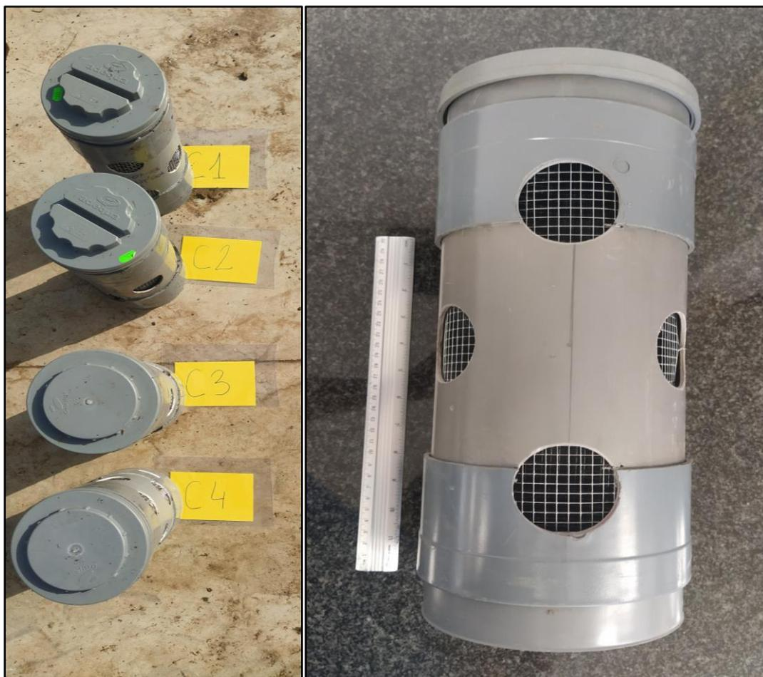
Figura 5. Detalle de los microcompostadores con los diferentes tratamientos (izq.) y tamaño (der.)
