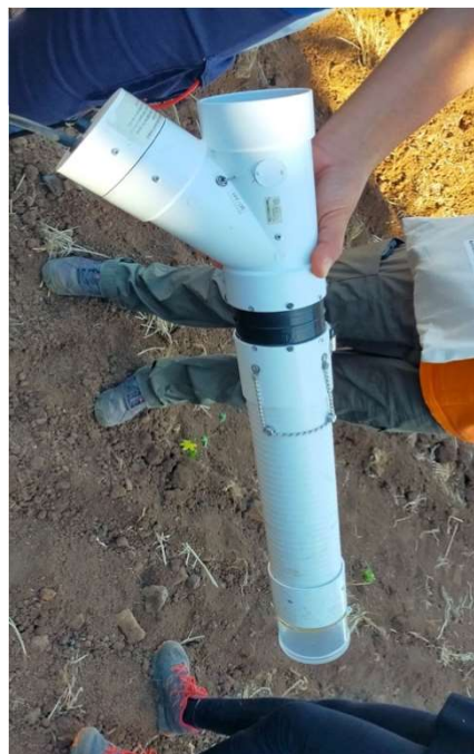
Figura 9: Arriba: aspirado. Izquierda: detalle aspirador usado
