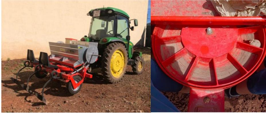
*Ilustración 16: Sembradora manual de dos surcos con sistema de dosificación. Autor: Armando Rodríguez.*
