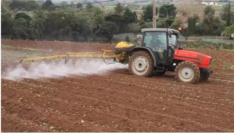
*Ilustración 18: Aplicación de herbicida con barras pulverizadoras. Autor: Armando Rodríguez*
