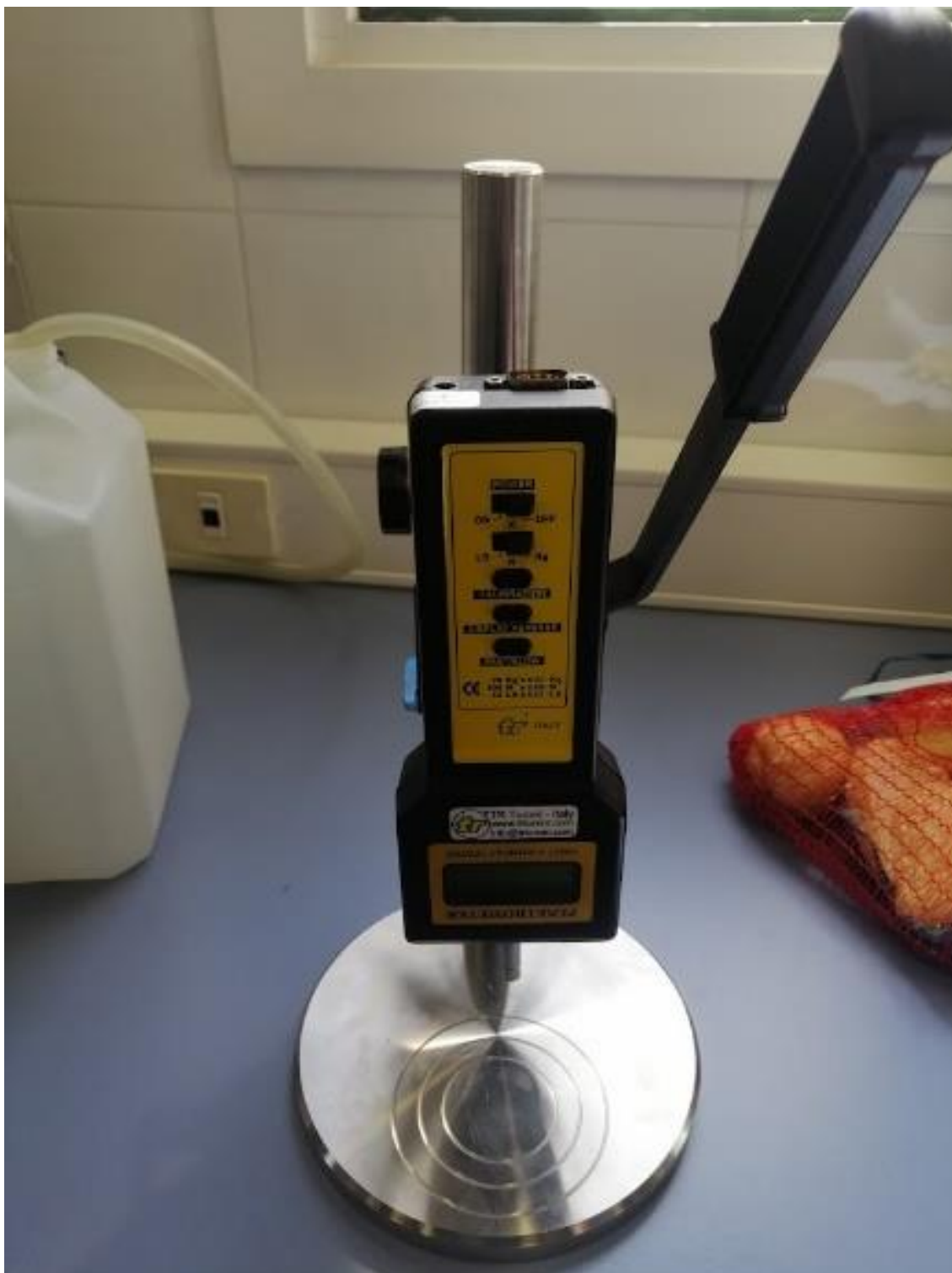
Figura 13. Penetrómetro digital Turoni sobre máquina de ensayo.
