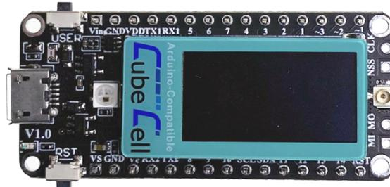
***Ilustración 17 CubeCell Dev-Board Plus (HTCC-AB02)***
