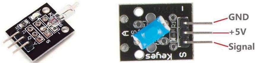
**Ilustración 20** *Tilt switch y diagrama de pines en encapsulado distinto*
