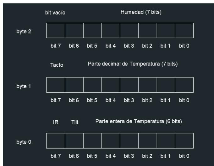
**Ilustración 34 Estructura de la payload**
