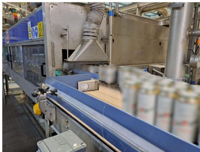
Figura 1.11. Túnel Pasteur (Mahou-San Miguel, s.f.)
