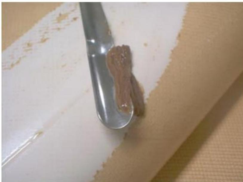
**Figura 23: Ensuciamiento coloidal en bastidor de membranas (Guía de desalación del Ministerio de Sanidad)**
