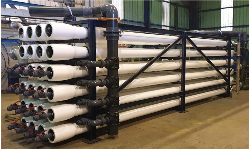
**Figura 22: Bastidor de membranas (ImWater)**
