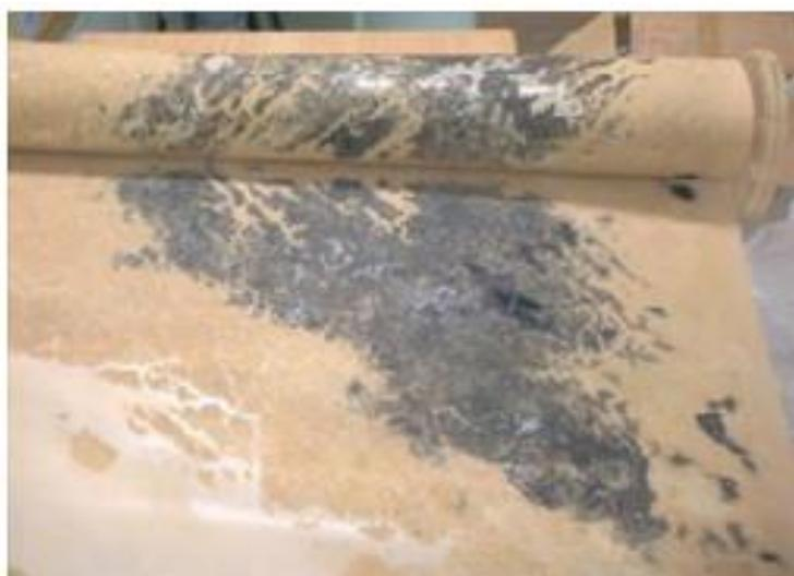
**Figura 25: Formación de biopelícula en bastidor de membrana de arrollamiento en espiral (Guía de desalación del Ministerio de Sanidad)**
