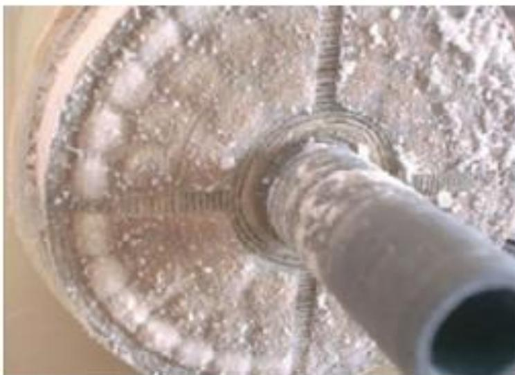
**Figura 24: Precipitación de sulfato de calcio en bastidor de membranas (Guía de desalación del Ministerio de Sanidad)**
