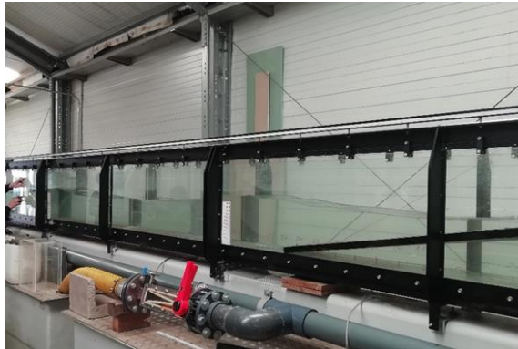
Figura 7: Oleaje producido en canal del laboratorio de la Escuela Politécnica Superior de Ingeniería de la ULL (Fotografía: Emilio Megías).
