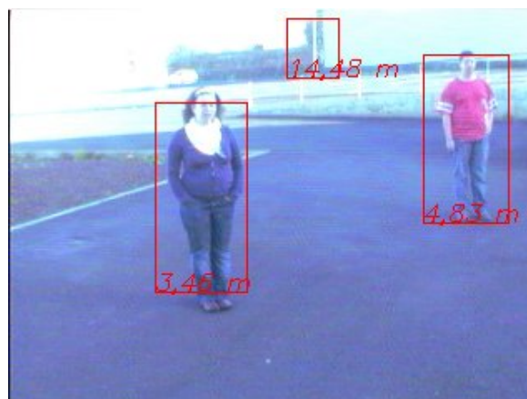
Figura 7.5: Ejemplo del resultado de la detección y medición de distancia hasta los obstáculos en un fotograma real.
