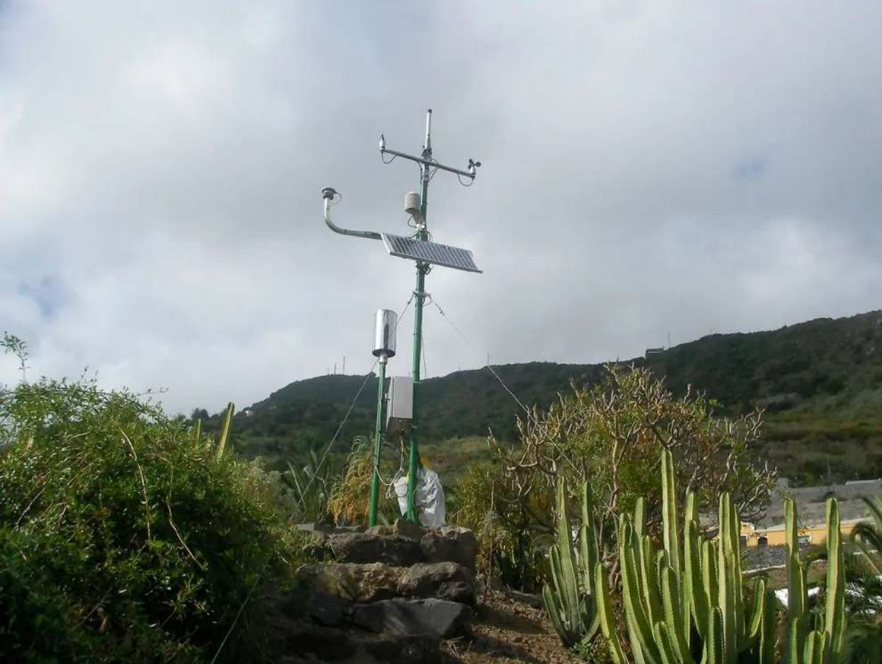
Fig. 16. Ejemplo de estación meteorológica automática en «Icod de los Vinos, Parque el Drago, a 200 m de altitud. Instalada en el Parque botánico del Drago de Icod, ayuda a conocer las condiciones medio ambientales del drago y, junto a otras estaciones próximas, facilita información para conocer las características climáticas» 21 .
