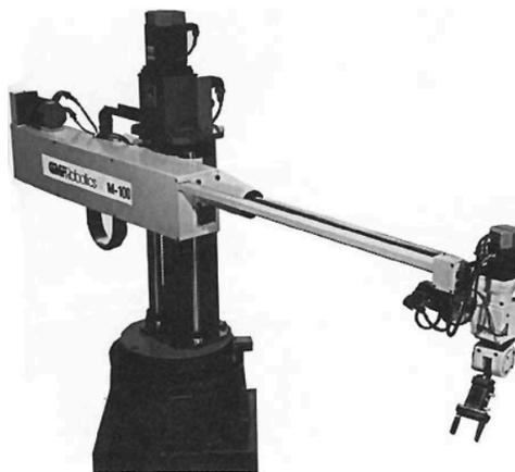
Figura 10 - Robot cilíndrico. Figura extraída de [15].
