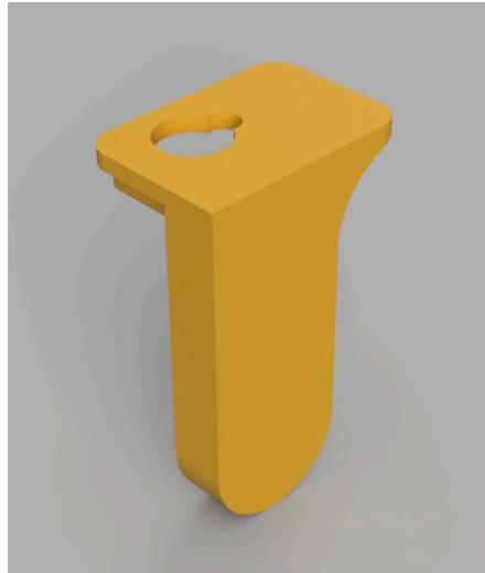
**Figura 55** - Segunda versión de la muñeca para facilitar el montaje del actuador.
