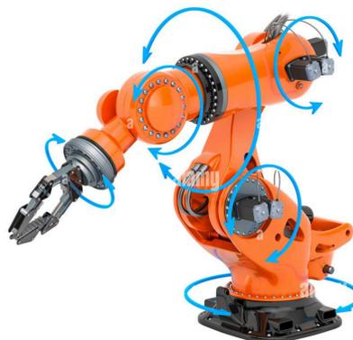
**Figura 6** - Brazo robótico con 6 ejes. Imagen extraída de [11].
