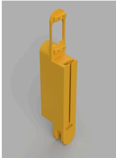
**Figura 53** - Segunda versión del hombro adaptada al nuevo servomotor.
