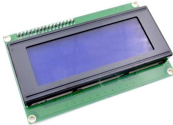
Figura 84 - Pantalla LCD de dimensiones 20x04.
