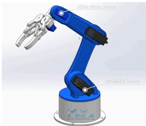
**Figura 22** - Brazo robótico fabricado con impresora 3D publicado en [31].
