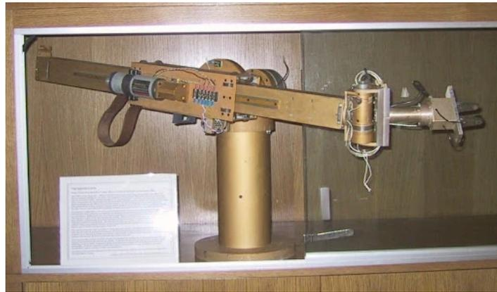
**Figura 3** - Stanford Arm, desarrollado por Victor Scheinman en 1968. Imagen extraída de [5].
