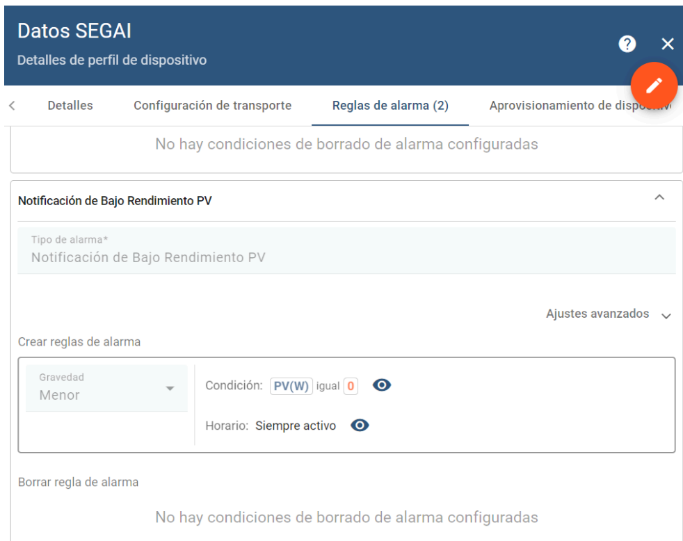
Figura 3.36: Alarma de bajo rendimiento PV.
