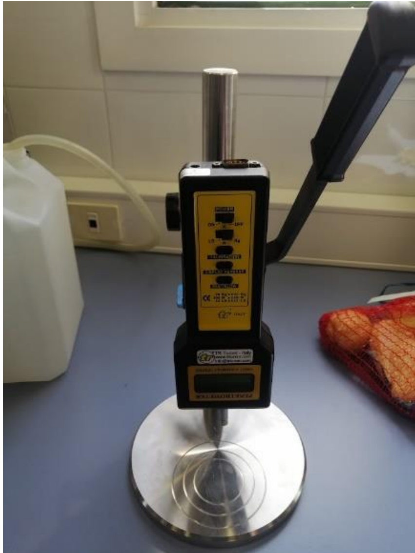
Figura 13. Penetrómetro digital Turoni sobre máquina de ensayo.
