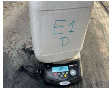
Fig. 4.17. Método de medición de las cantidades de solución y drenaje,
