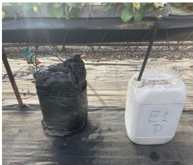
Fig. 4.16. Estación del ensayo con una garrafa para recoger los aportes y otra para recoger el drenaje.
